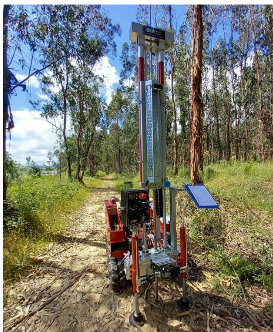
Figura 3.11 - Equipamento DPSH posicionado no campo.
