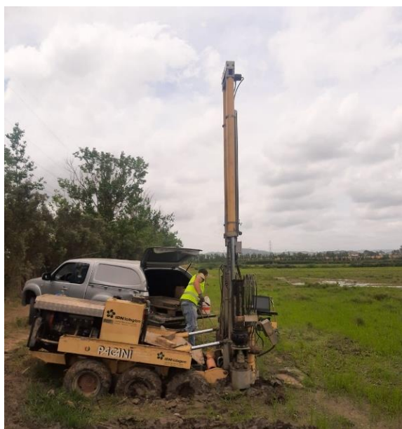
Figura 3.13 - Equipamento a realizar um ensaio CPTu.
