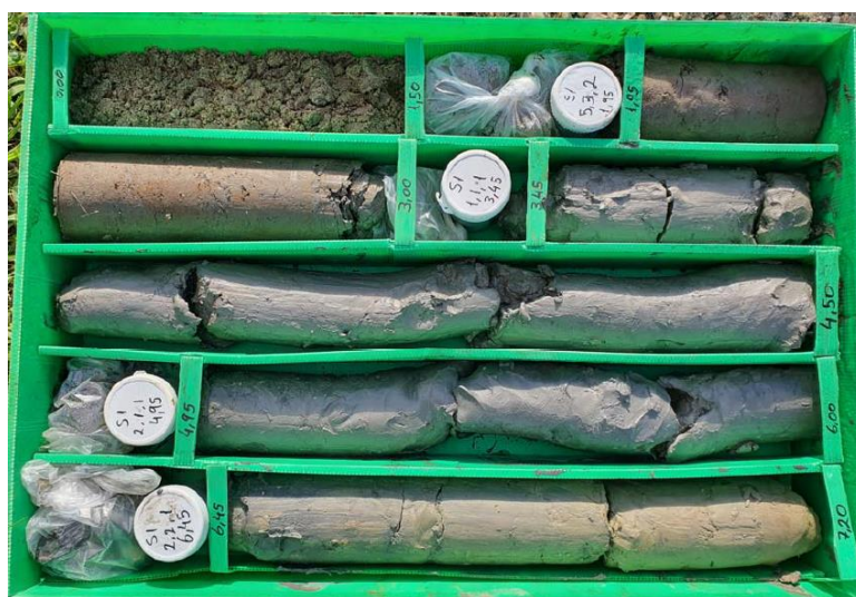
Figura 3.7 - Caixa de sondagem preenchida com os testemunhos.
