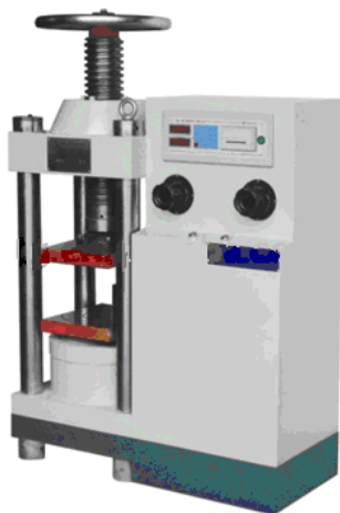
Figura 3.14 - Equipamento - prensa, utilizada para realizar o ensaio de resistência à compressão uniaxial.
