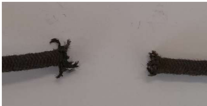
Figura 3.14: Correia de secção circular danificada (Local do defeito).
