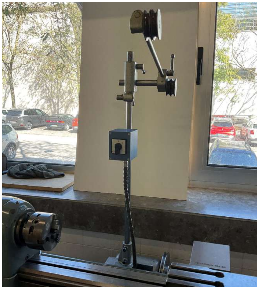
Figura 3.11: Interruptor manual para acessórios suplementares de operações de fresagem após recuperação.
