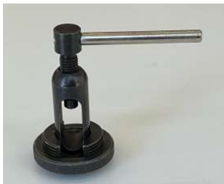
Figura 3.30: Porta ferramenta de um parafuso recuperado.
