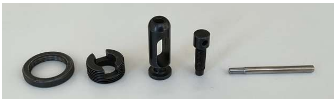
Figura A.7: Componentes que compõe o porta ferramenta de 1 parafuso (da esquerda para a direita): anel roscado, casquilho roscado, suporte de ferramenta, parafuso e manivela.
