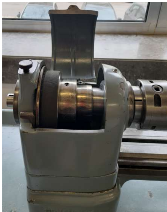
Figura A.11: Cabeçote fixo com acesso às polias e correia.
