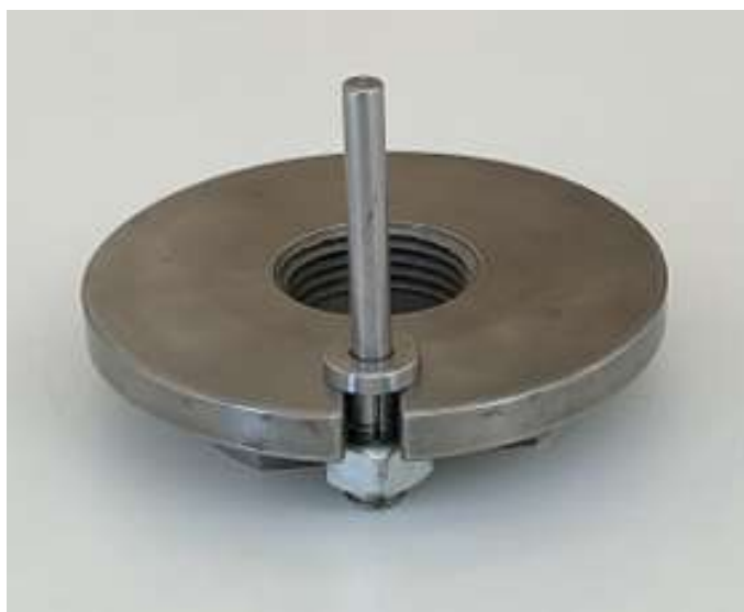
Figura 3.21: Prato de arrastamento recuperado.
