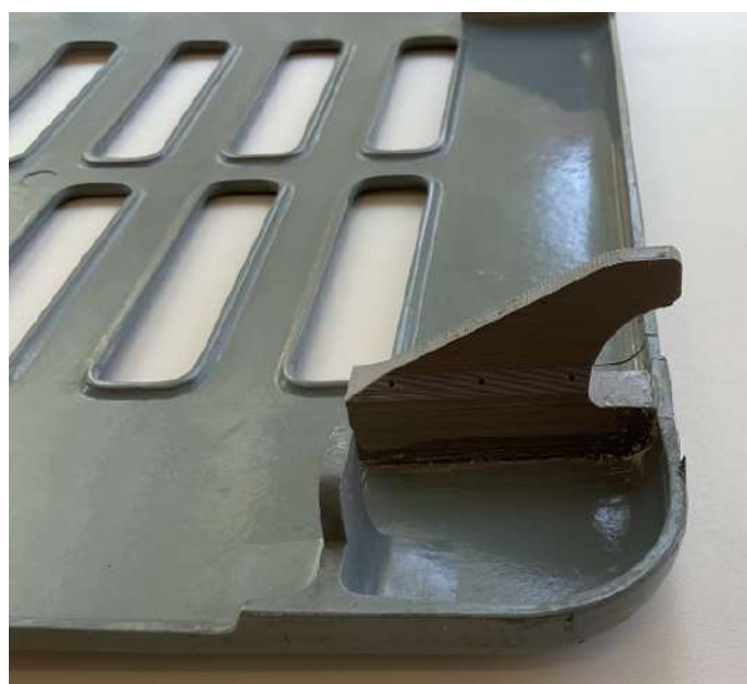
Figura 3.28: Porta lateral direita (patilha recuperada).
