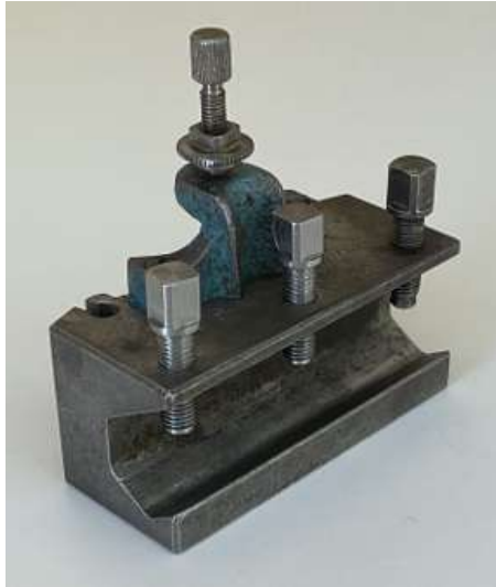
Figura 3.32: Porta ferramentas 102-46.230 recuperado.
