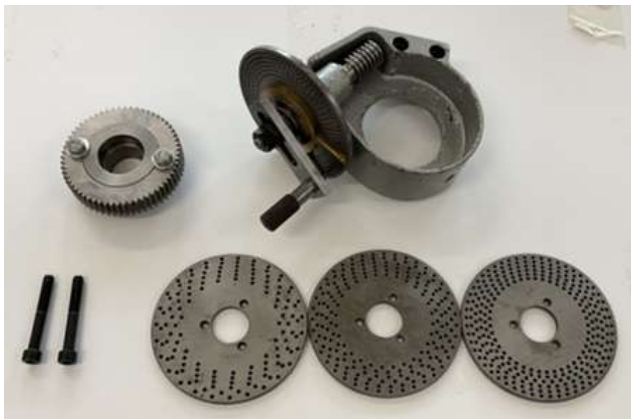
Figura A.8: Componentes que compõem o prato divisor.
