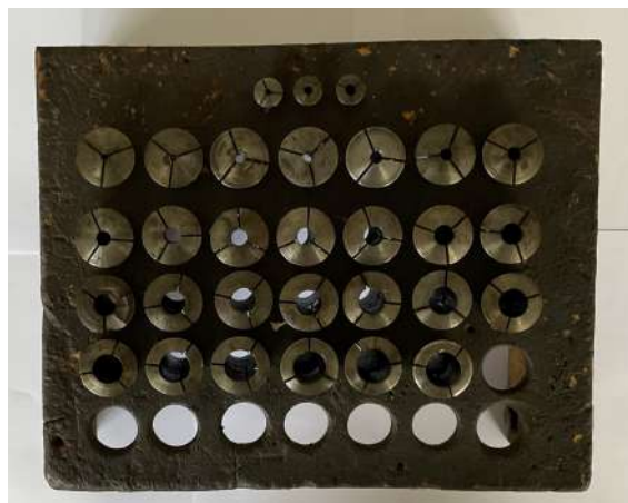
Figura 3.34: Suporte para pinças W20 e B8 degradado.
