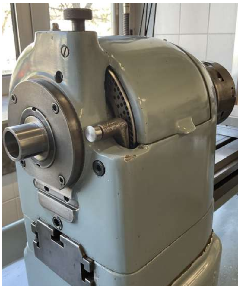
Figura A.6: Prato divisor integrado após fabrico e instalação no pino.
