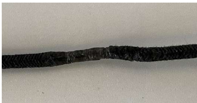
Figura 3.15: Correia de secção circular recuperada (Local da intervenção).
