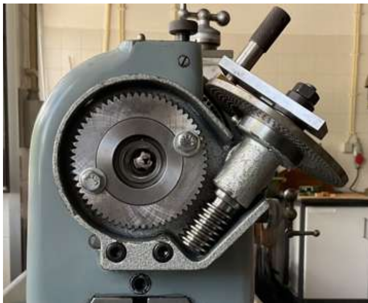
Figura 3.25: Prato divisor instalado.
