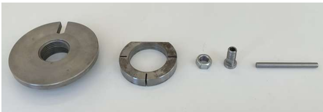
Figura A.4: Componentes que compõe o prato de arrastamento (da esquerda para a direita): prato, anel de fixação, porca, fixador e pino.
