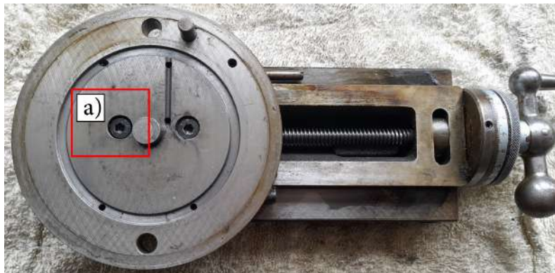
Figura 3.36: Carro longitudinal (vista inferior): a) Parafuso de fixação defeituoso.
