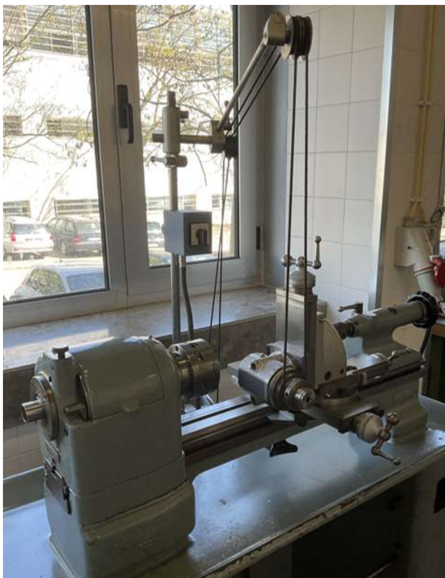
Figura A.12: Instalação de acessórios para fresagem e retificação e acessórios suplementares.
