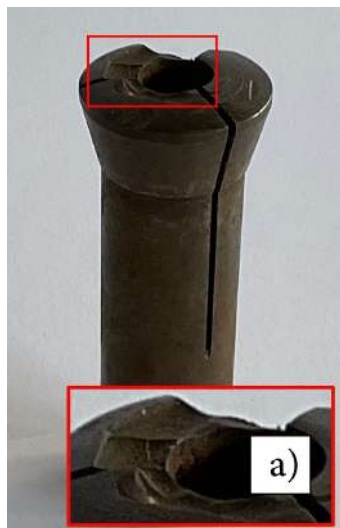
Figura 3.33: Pinça W20 de \varnothing 10 : a) Vista de pormenor do defeito.
