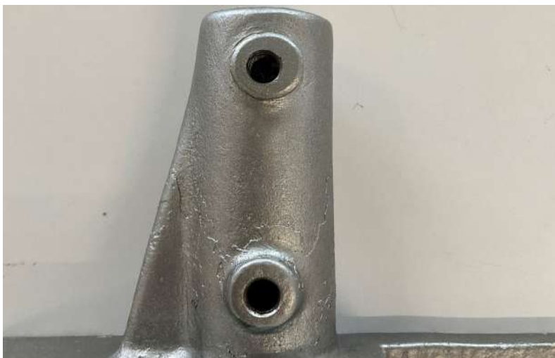
Figura 3.13: Suporte para motor 6.050 recuperado.
