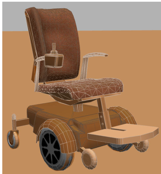
Figura 3.28: Áreas de colisão dos links do modelo da cadeira
