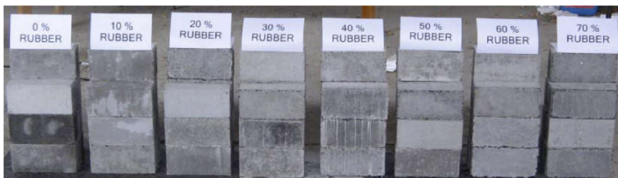
Figura 2.3 - Tijolos de cimento reforçados com pedaços de borracha, [15].
