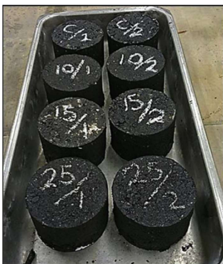
Figura 2.6 - Provetes de asfalto com beatas encapsuladas no interior, [21].
