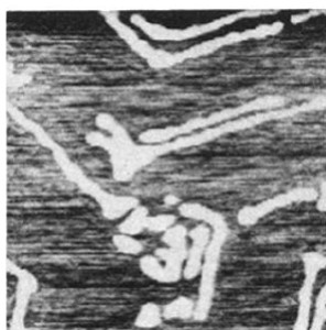
Figura 6.12: Imagem de STM da superfície (111) do ouro com 0,25 ML de prata [74].
