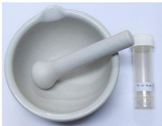
Figura 20 - Almofariz, pilão e pó de teste usados para fazer as pastilhas.
