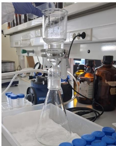
Figura 8 - Processo de filtração das amostras com recurso à bomba de vácuo.
