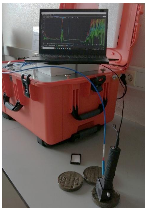
Figura 9 - Sensor NIR em utilização no laboratório.
