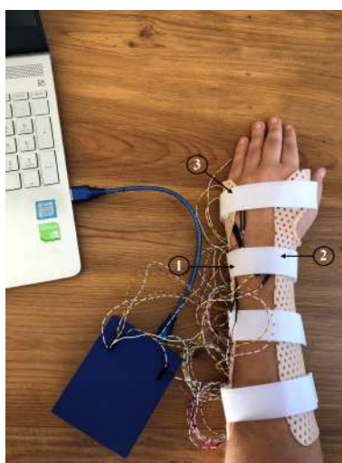
Figura 5.2: Configuração experimental utilizada para aquisição de dados: na extremidade distal da ulna (1), na extremidade distal do rádio e próximo à tabaqueira anatômica (2) e no ponto mais proeminente do abdutor do dedo mínimo (3).
