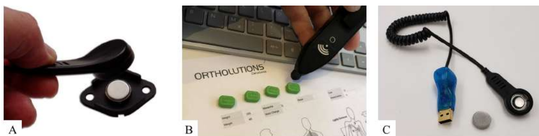
Figura 3.1: Dispositivos de monitorização da adesão através de sensores de temperatura. A: iButton. Retirado de [86]. B: Orthotimer. Retirado de [87]. C: stTracker®. Retirado de [85].
