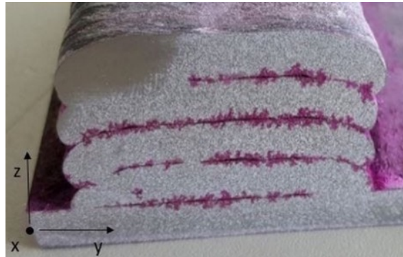
Figura 2.10 – Utilização do método dos líquidos penetrantes que evidencia a falta de fusão entre camadas numa peça fabricada por WAAM [45].
