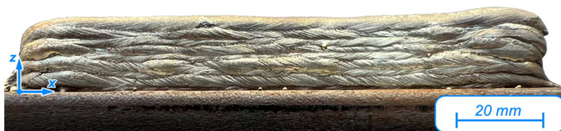
Figura 5.6 - Parede de referência fabricada por WAAM do Ensaio 3 (Ref-E3).
