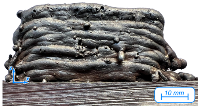
Figura 5.4 – Parede fabricada por WAAM no Ensaio 1 na célula robótica.
