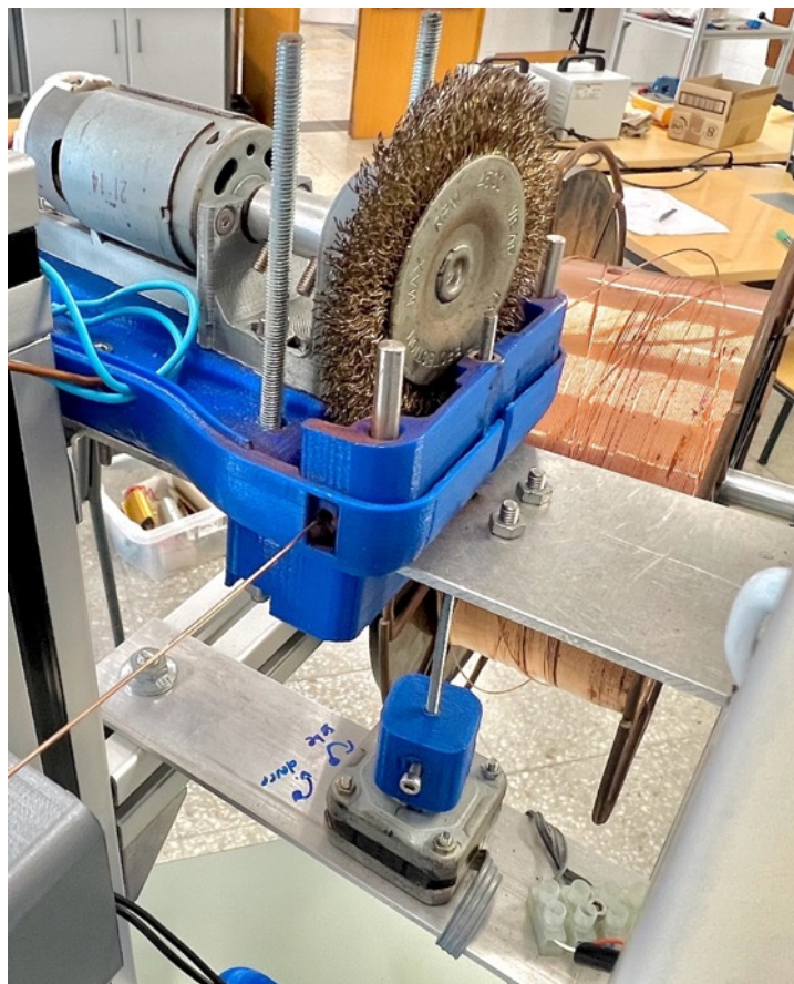
Figura A5 - UL Superior produzida sem a carcaça superior, onde se pode observar o rolete de escova de aço que atua sobre o fio de soldadura oxidado.
