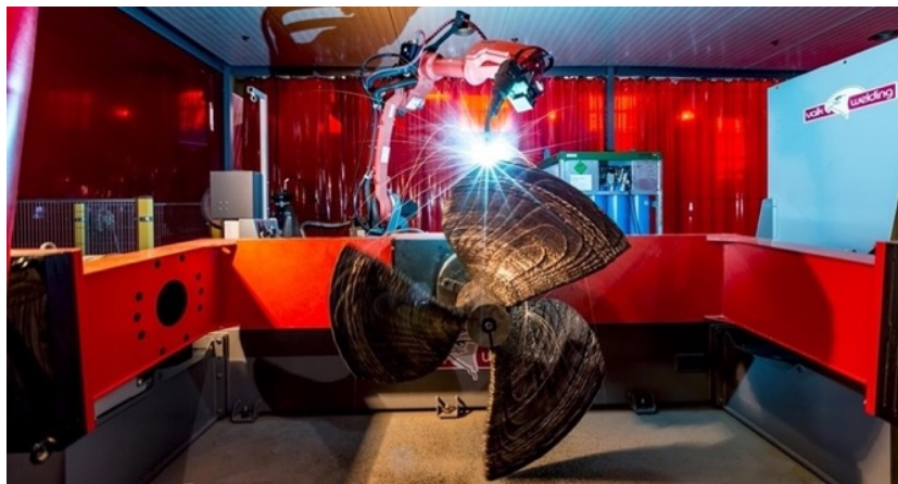
Figura 2.5 - Exemplo do FA por WAAM de pás de turbinas e da automatização do processo [24].
