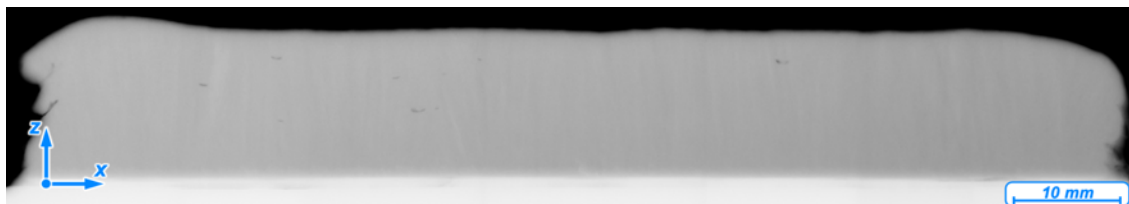
Figura 5.18 – Raio-X efetuado à parede E3.
