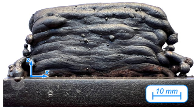
Figura 5.3 – Parede de referência fabricada por WAAM dos Ensaio 1 e 2 (Ref-E1-E2).
