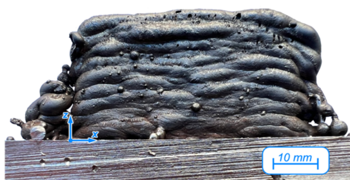
Figura 5.5 - Parede fabricada por WAAM no Ensaio 2 na célula robótica.
