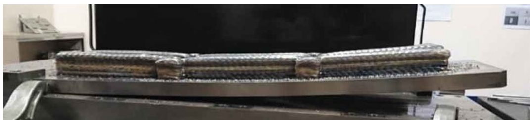
Figura 2.9 – Distorção numa peça fabricada por WAAM devido a tensões residuais. Adaptado de [39].
