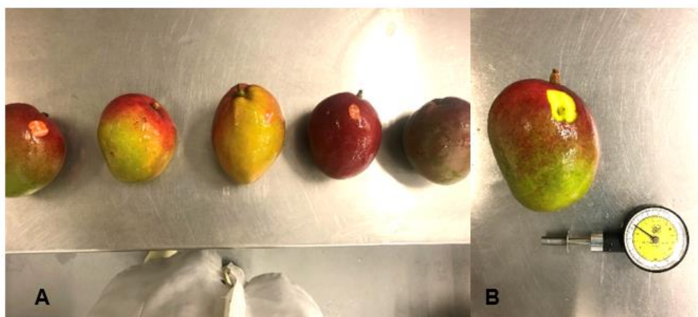
Figura 4.1-Manga: A-Amostragem para análise recolhida no dia 16 de Março; B- medição de dureza da manga com auxílio de penetrómetro.
