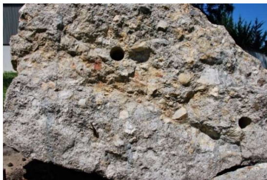
Figura 1.7 – Aspeto amarelado do betão da barragem do Alto Ceira (bloco que está no campus do LNEC, fotografado em 2020) (à esquerda) e hasteal de uma galeria com betão deteriorado superficialmente na barragem de Bem-posta, em 2013 (à direita)
