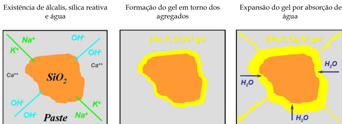
Figura 1.1 - Esquema dos mecanismos químicos das reações álcalis-sílica (adaptado de (Thomas et al., 2013))
