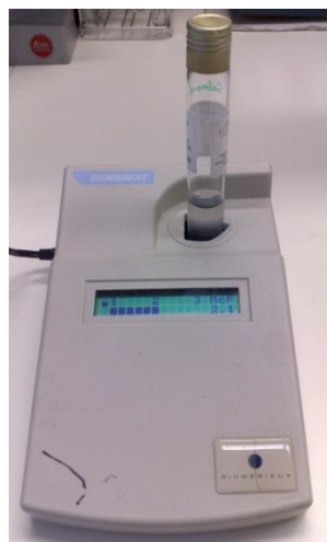
Fig. 12: Aparelho densimat (biomérieux) utilizado para medir a densidade de células bacterianas.
