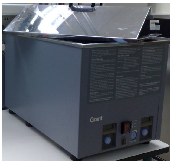
Fig. 11: Banho termoestatizado a 20 \pm 1^\circ\text{C} onde se efectuaram os testes e banho termoestatizado a 45 \pm 1^\circ\text{C} para manter derretidos os meios de cultura.
