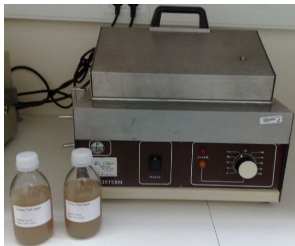
Fig. 11: Banho termoestatizado a 20 \pm 1^\circ\text{C} onde se efectuaram os testes e banho termoestatizado a 45 \pm 1^\circ\text{C} para manter derretidos os meios de cultura.
