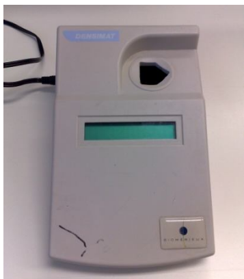
Fig. 12: Aparelho densimat (biomérieux) utilizado para medir a densidade de células bacterianas.
