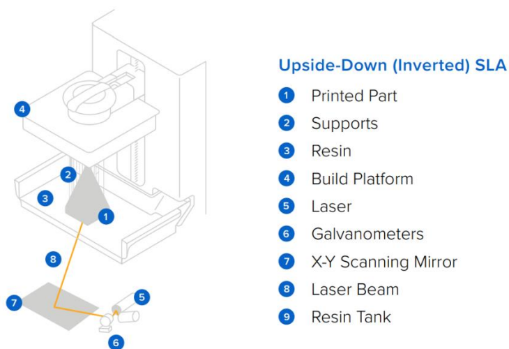
Figura 2.12 – Representação do processo de stereolithography bottom-up. Adaptado de [31].
