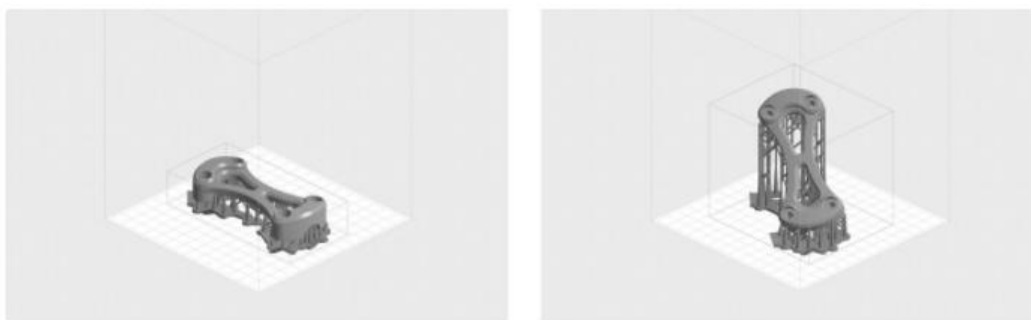
Figura 2.15 - Orientação de uma peça para imprimir de cima para baixo e de baixo para cima, respetivamente. Adaptado de [18].
