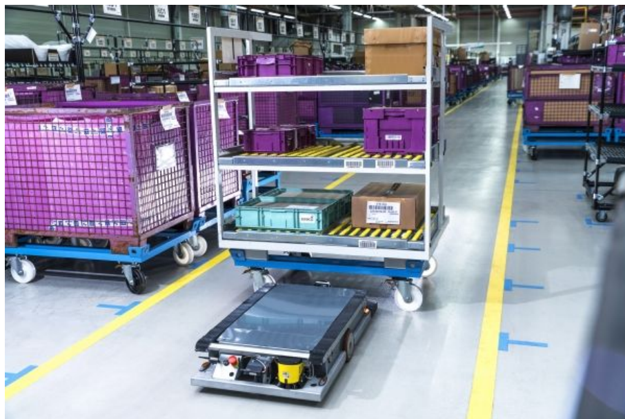
Figura 2.1: Exemplo de um AGV em fábricas do grupo BMW (retirado de [9])
