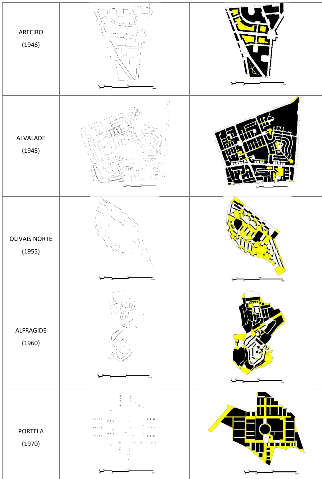
Figura 6.3 – Mapas de Constituição, Espaços Convexos e Espaços Cegos. Esquerda: constituição do espaço aberto pelas entradas dos edifícios. Direita: divisão do espaço aberto em espaços convexos e de entre estes os espaços cegos (amarelo) ou seja os que não são constituídos por nenhuma entrada de edifício (Desenhos de autor).
