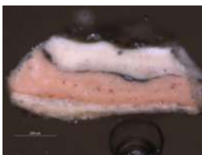
Figura 4.24. Local de recolha da amostra FC_70-20-5 e respectivo corte estratigráfico, com ampliação de 110x.
