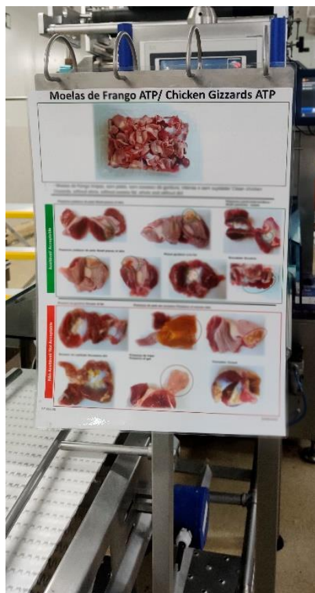
Figura 4.40 - Especificações linha de embalagem em ATP
