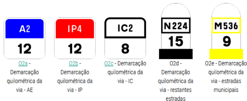
Figura 4.17: Marcação quilométrica de vias (retirado de [33]).
