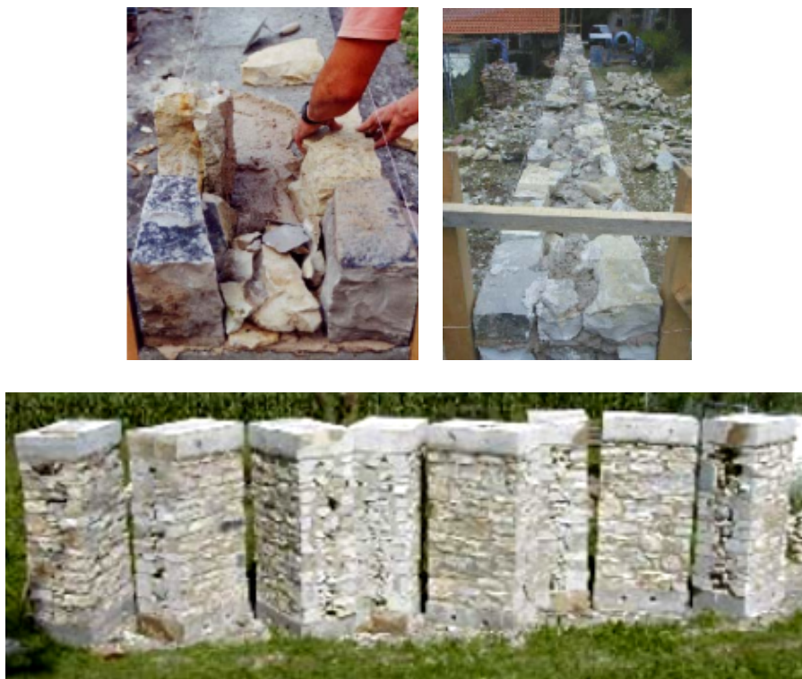
Fig. 3.20 - Fases construtivas e aspecto final dos modelos experimentais do estudo de M. R. Valluzzi [57]
