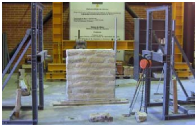
Fig. 3.11 – Dispositivo de ensaio cíclico laboratorial do modelo de H. Varum et al. [58]
