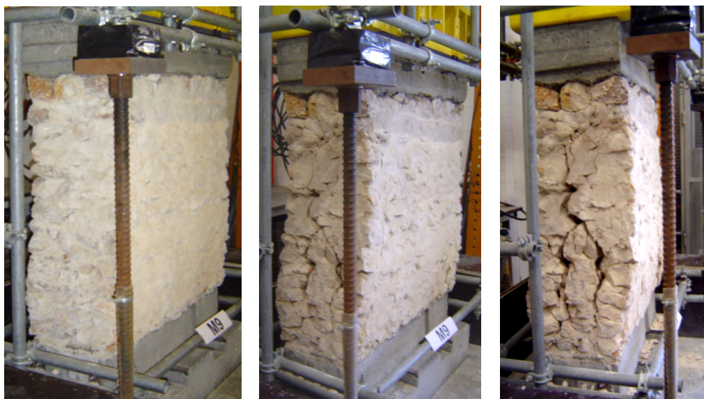
Fig. 5.11 - Ensaio de compressão axial sobre o murete M9 – vista lateral Norte
