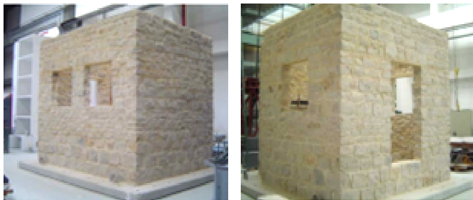
Fig. 3.8 - Modelo à escala real de um edifício de alvenaria de pedra, do estudo de E. Coelho e P. Candeias, antes de ser ensaiado [15]
