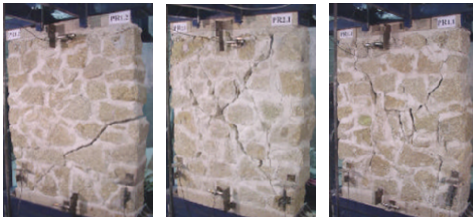
Fig. 3.7 – Modos de rotura dos modelos de alvenaria com aparelho irregular (PR), do estudo desenvolvido por G. Vasconcelos [59]
