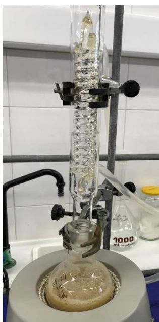
Figura 2.5 - Conjunto de montagem extração por aquecimento e refluxo
