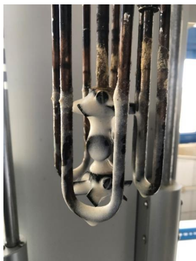
Figura 3.13 - Agregação de partículas no agitador do reator de hidrólise com água subcrítica
