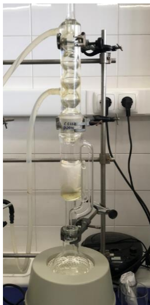
Figura 2.2 - Ilustração da montagem de sistema de extração soxhlet utilizado
