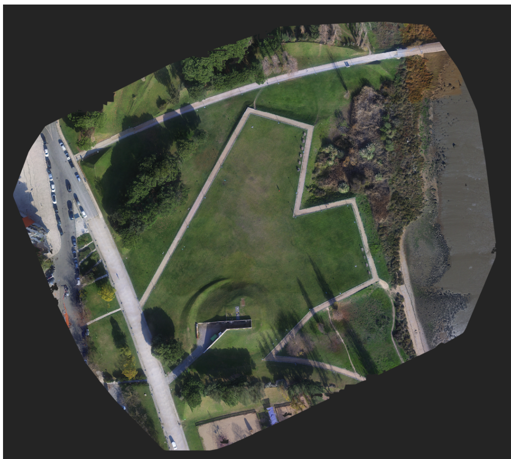
Figura 2.7: Ortomosaico obtido através do processamento das imagens no WebODM, aquando do levantamento topográfico efetuado no Parque das Nações no dia 17/12/2021.
