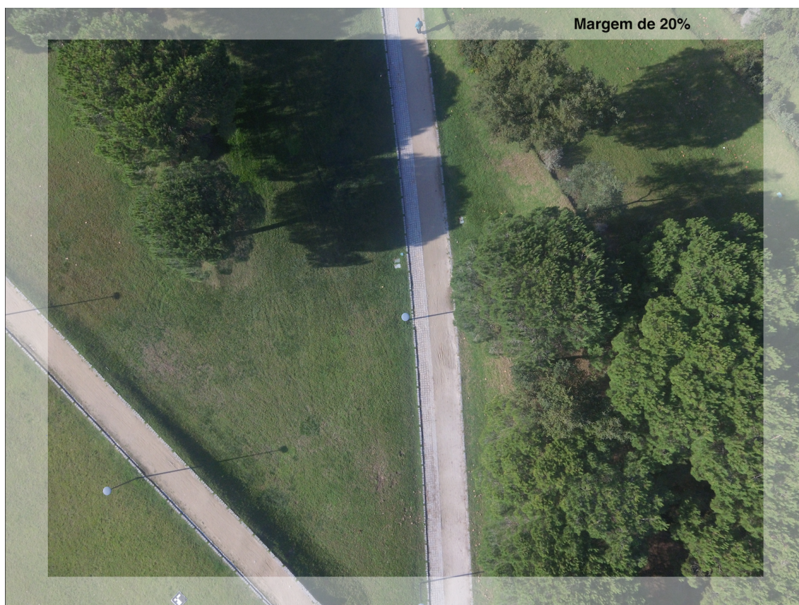
Figura 4.1: Área selecionada pelo software caso seja utilizada uma margem de 20%.
