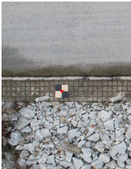
Figura 2.4: Identificação correta do centro do GCP.
