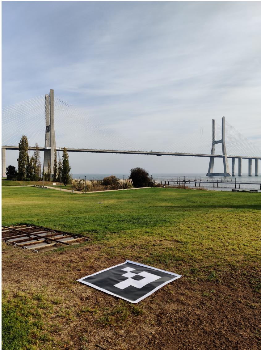
Figura 4.7: GCP com id=0 utilizado no levantamento topográfico de dia 17/12/21.
