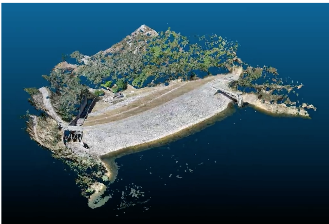
Figura 5.2: Nuvem de pontos da Barragem da Lapa gerada pelo WebODM utilizando as imagens recolhidas no levantamento efetuado dia 19/05/2022.
