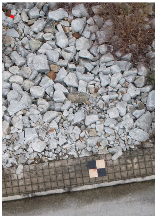
Figura 2.5: Identificação incorreta do centro do GCP no canto superior esquerdo.
