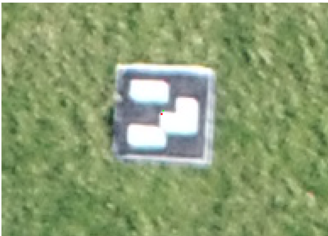
Figura 5.3: Identificação do centro de um ponto de controlo feita pelo algoritmo GCP Finder. A vermelho tem-se a identificação utilizando a mediana dos lados, e a verde utilizado a intersecção das diagonais. A imagem foi ampliada e capturada a 60 m de altura.
