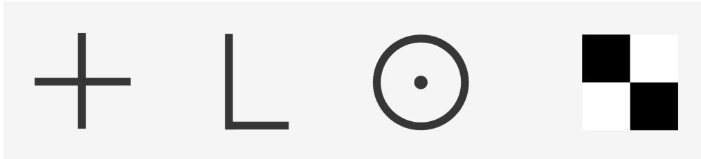
Figura 2.8: GCP normalmente utilizados no mapeamento de território.
