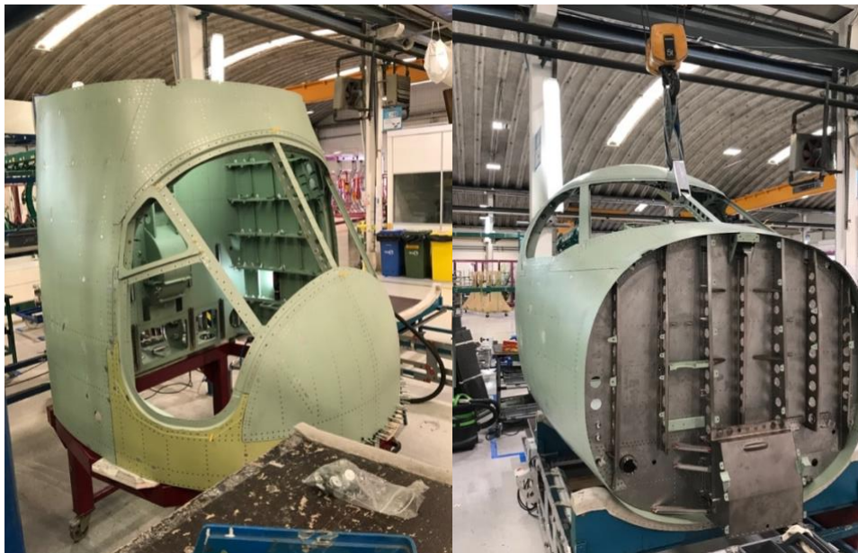
Figura 3.10 - Fase vertical e horizontal de OutJig respetivamente
