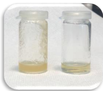
Figura 8: Dissolução da Qc em EMIm·OAc (polytop esquerda) e dissolução da Qc em HOAc (polytop direita).
