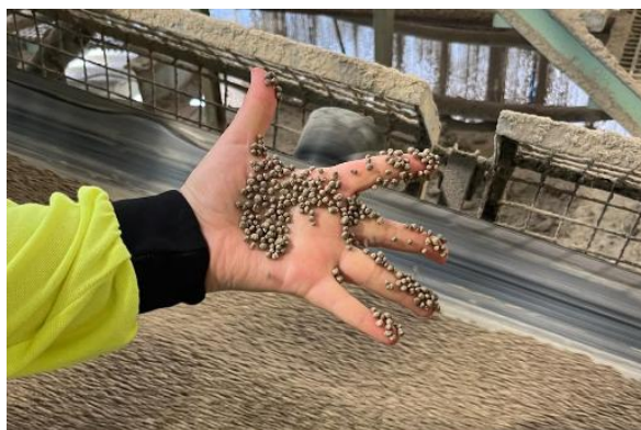
Figura 4.17- Aderência dos grânulos à mão indicando material pegajoso
