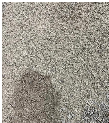
Figura 3.2- Pó presente na superfície da tulha
