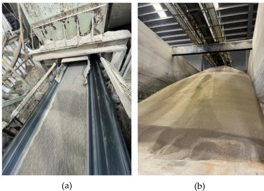
Figura 3.1- Locais onde foram retiradas amostras: a) tapetes transportadores; b) Tulha.
