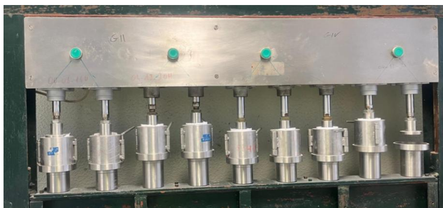
Figura 3.6- Unidade de aglomeração utilizada para determinar o índice de caking
