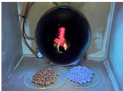
Figura 2.11- Comparação do produto sem revestimento (à esquerda) e com revestimento (à direita) quando exposto à luz UV.
