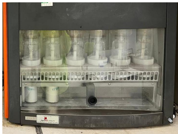
Figura 3.4- Equipamento SOXTEC 20250 AVANTI para determinação do teor antiaglomerante nas amostras
