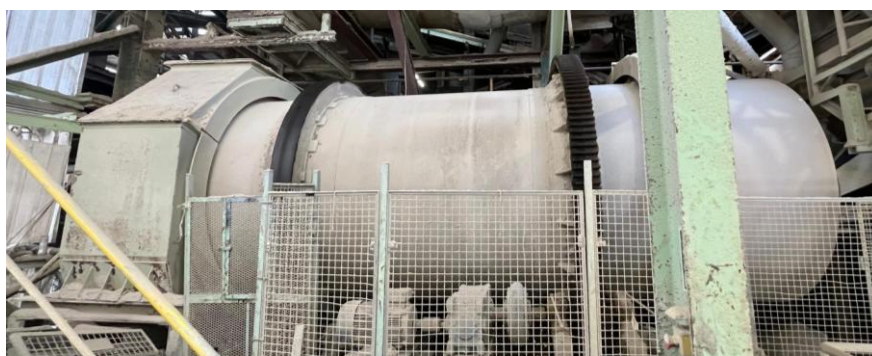
Figura 2.3- Tambor rotativo onde é aplicado o revestimento líquido e talco no produto
