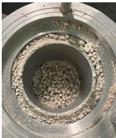
Figura 4.11- Partículas finas produzidas após abrasão das partículas devido ao tempo prolongado de teste
