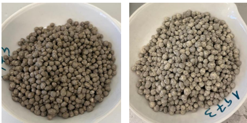
Figura 4.18- Amostras recolhidas: a) dose de talco baixa; b) dose de talco elevada.
