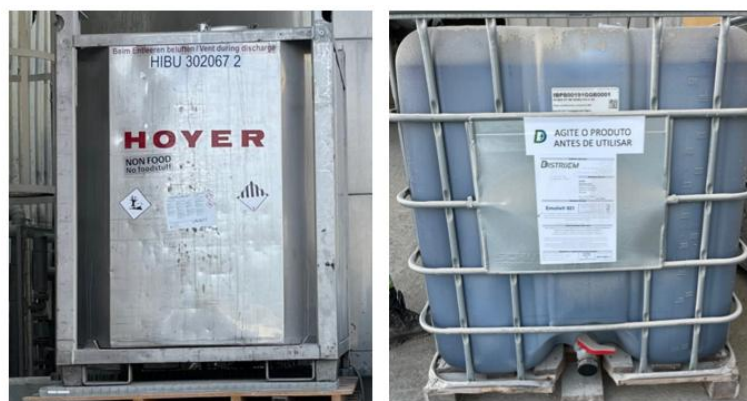
Figura 3.11- Depósitos auxiliares de revestimentos: a) Freeflow 971; b) Emulix 921
