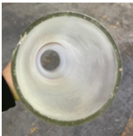
Figura 4.9- Pó acumulado nas paredes da coluna
