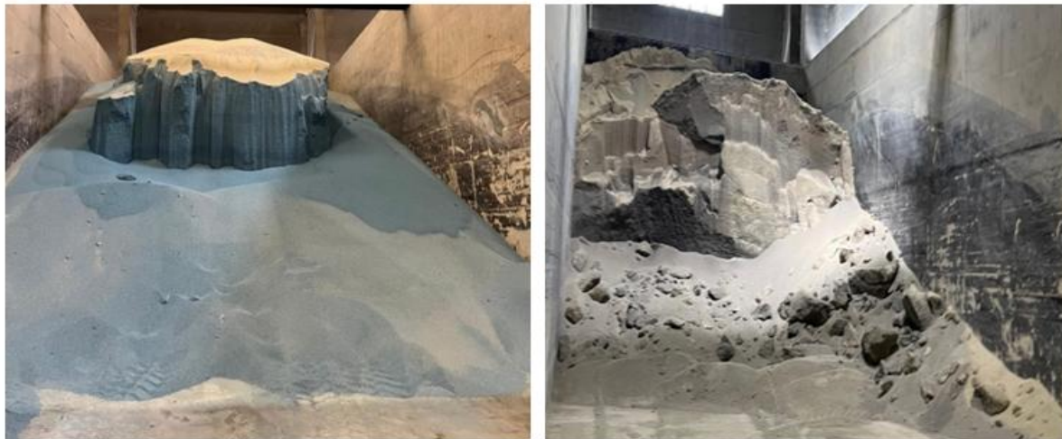
Figura 2.9- Exemplos práticos do fenómeno caking no armazenamento em tulha
