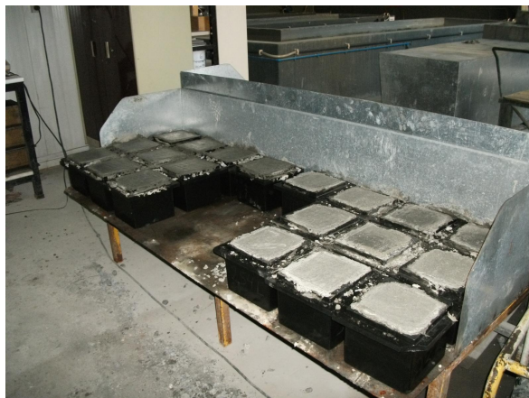
Figura 3.5: Endurecimento dos provetes nos moldes.
