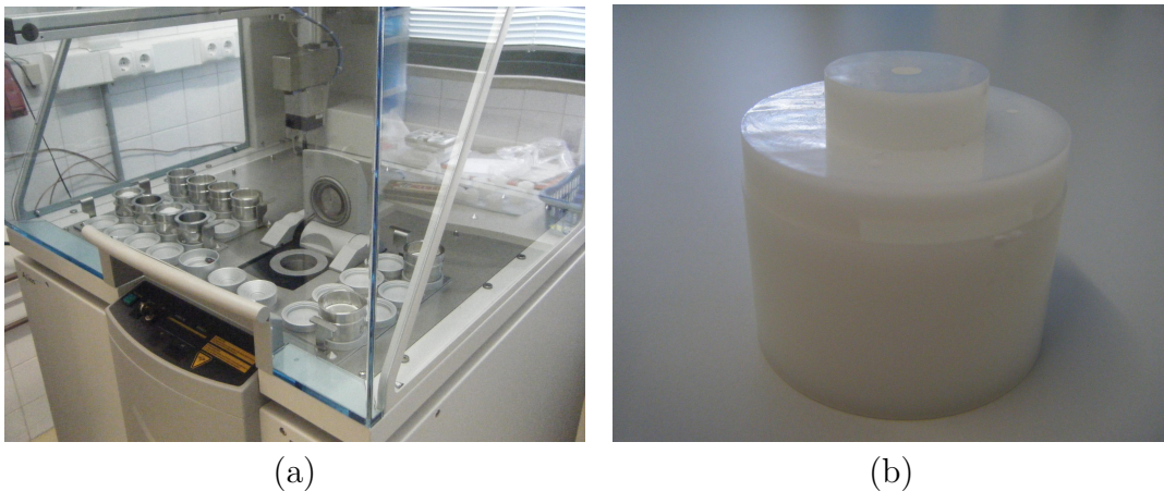
Figura 3.18: Análise de FRX: (a) espectrómetro de raios-X; (b) porta-amostras.
