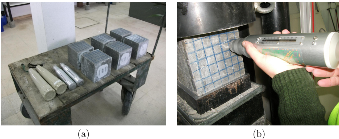
Figura 3.10: Ensaio esclerométrico aos provetes cúbicos: (a) provetes com marcação quadriculada prontos a ensaiar e os dois esclerómetros utilizados; (b) ensaio a um provete.
