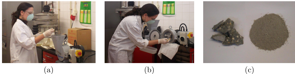
Figura 3.15: Moagem: (a) alimentação do moinho com o material; (b) remoção do excesso de material do interior do moinho; (c) pedaços e pó obtido.
