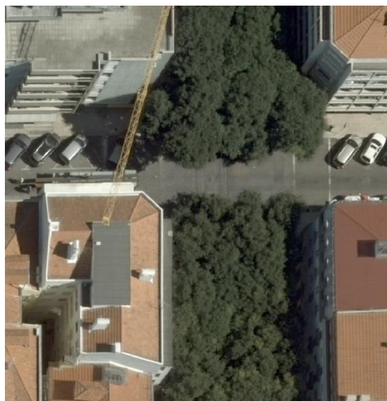
Figura 18 - Omissão de arruamento devido à existência das copas de árvores
