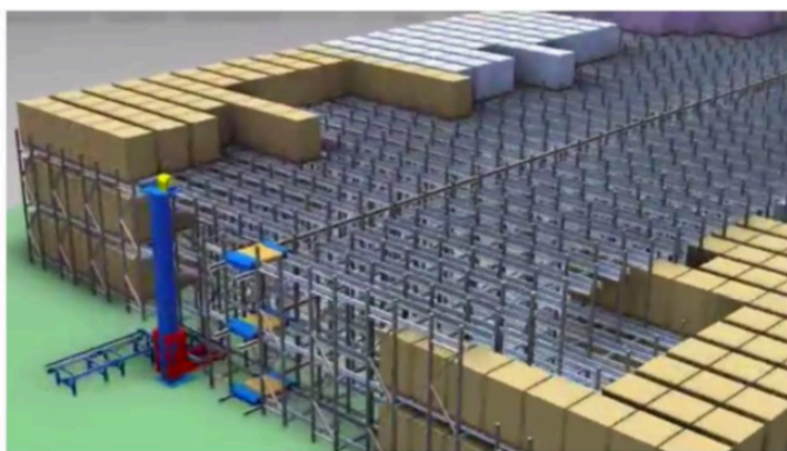
Figura 3.9 - Armazenamento compacto baseado em shuttles e elevadores [31]
