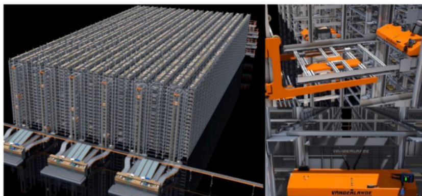
Figura 3.10 – Armazenamento em estantes baseado em shuttles (Adaptado de [1])
