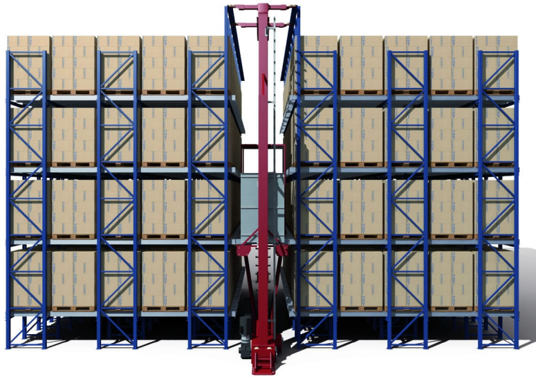
Figura 3.5 – Armazenamento compacto em estantes [27]
