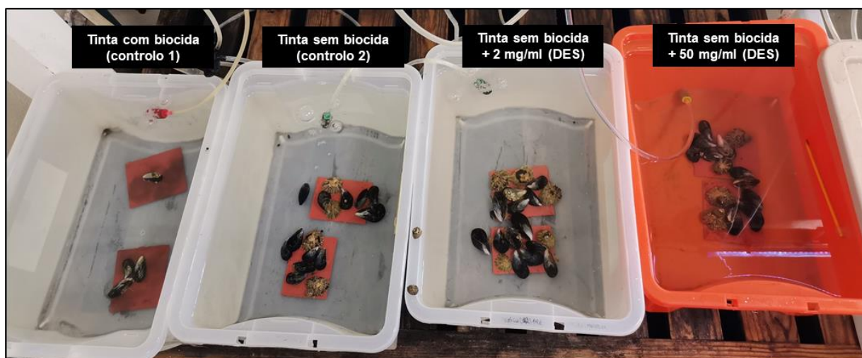
Figura 2.2. Ensaio relativo à simulação da aplicação da tinta náutica com o sistema Men:OL (1:1) em possíveis estruturas do ambiente marinho (primeira parte). Distribuição e respetiva identificação dos tanques (10L de água salina sintética) com as placas correspondentes e os organismos marinhos em estudo.
