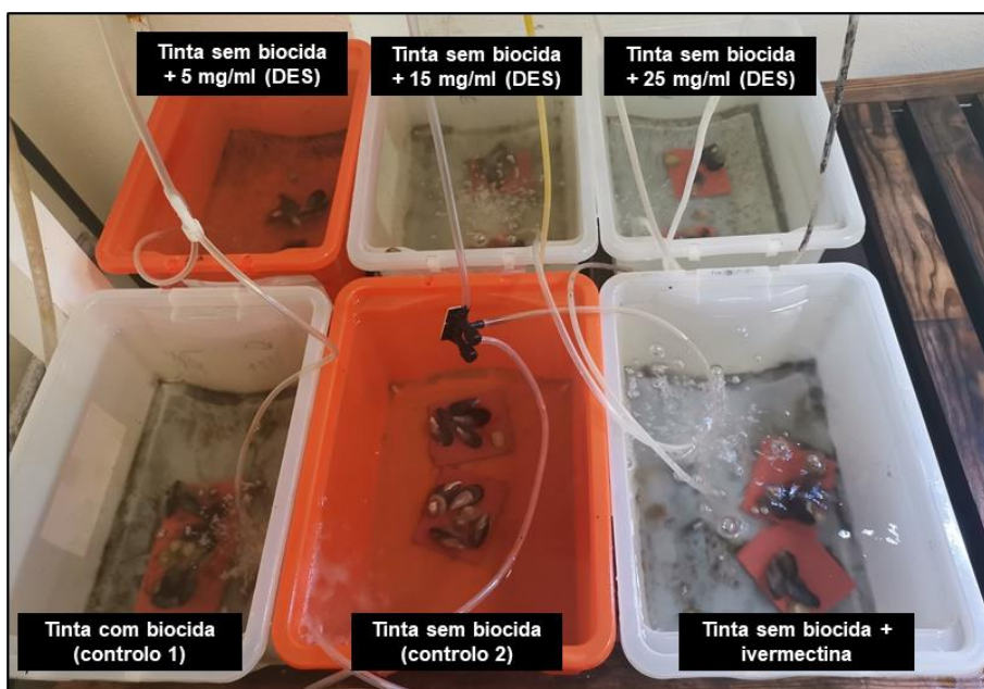
Figura 2.3. Ensaio relativo à simulação da aplicação da tinta náutica com o sistema Men:OL (1:1) em possíveis estruturas do ambiente marinho (segunda parte). Distribuição e respetiva identificação dos tanques (10L de água salina sintética) com as placas correspondentes e os organismos marinhos em estudo.
