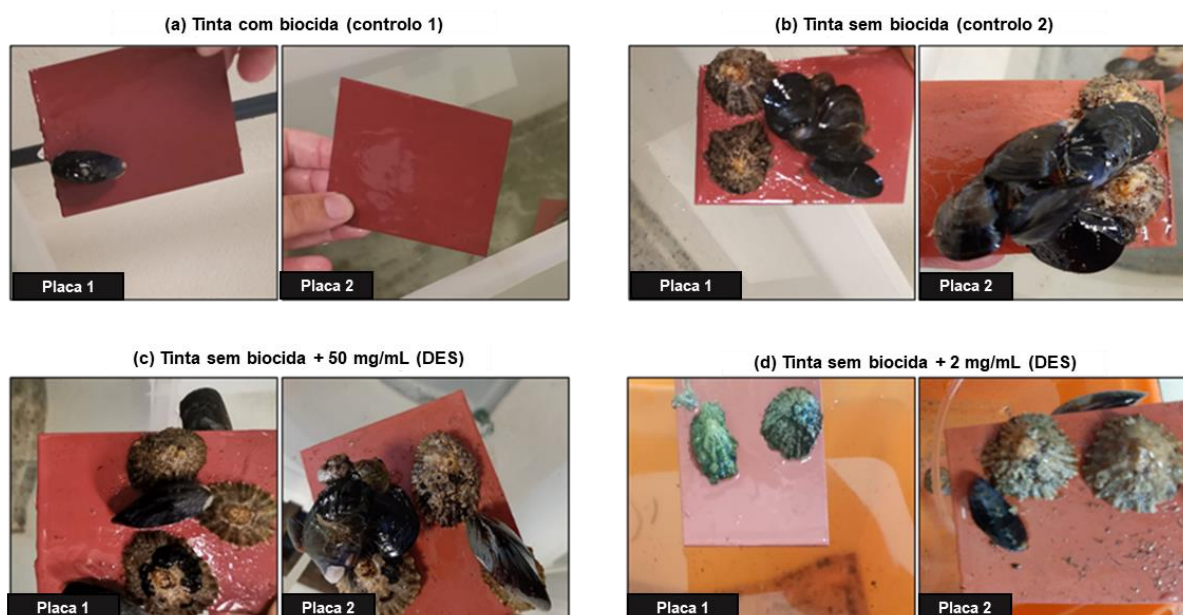
Figura 3.12. Aplicação do sistema Men:OL (1:1) em tinta náutica. Análise da evolução do processo de fouling exercido pelos organismos marinhos - dia 3 (16/07/2021). Na imagem estão apresentadas as duas placas em teste correspondentes aos respetivos tanques.
