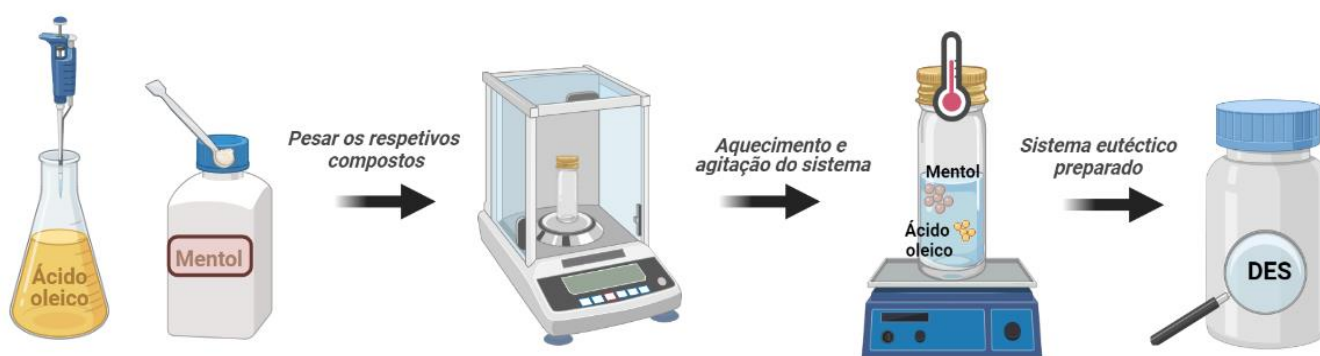
Figura 2.1. Preparação dos DES. Ilustração dos passos envolvidos na formação dos sistemas eutéticos, sendo este exemplo alusivo ao sistema Men:OL.
