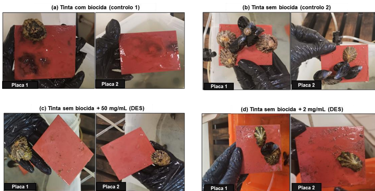
Figura 3.13 Aplicação do sistema Men:OL (1:1) em tinta náutica. Análise da evolução do processo de fouling exercido pelos animais - dia 6 (19/07/2021). Na imagem estão apresentadas as duas placas em teste correspondentes aos respectivos tanques.
