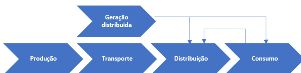
Figura 2.4: Fluxo das redes de transporte e distribuição de energia com GD
