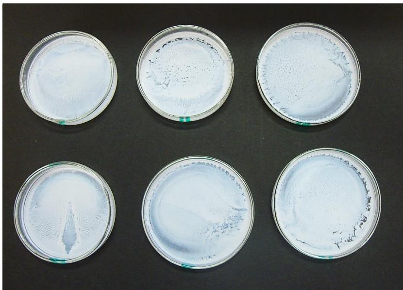
Figura III. 5- Procura na obtenção de transparência no líquido sobrenadante de solução TiO 2 e isopropílico, depositado num vidro de relógio (1ml) após: (A) 5min; (B) 10 min; (C) 15 min; (D) 30 min; (E) 60 min; (F) 90 min.
