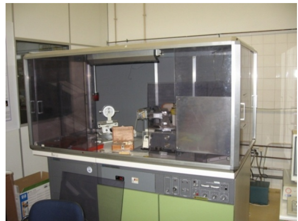
Figura 3.9 – a) Interferência construtiva (lei de Bragg); b) Difractómetro Rigaku DMAX III-C.
