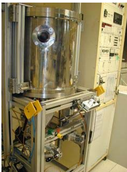
Figura 3.4 – Sistema utilizado na evaporação de metal assistida por canhão de electrões.
