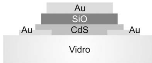
Figura 6.2 – Esquema do primeiro TFT produzido por Weimer. Adaptado da referência [7].
