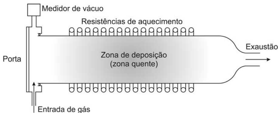
Figura 2.1 – Esquema de um reactor típico de LPCVD .
