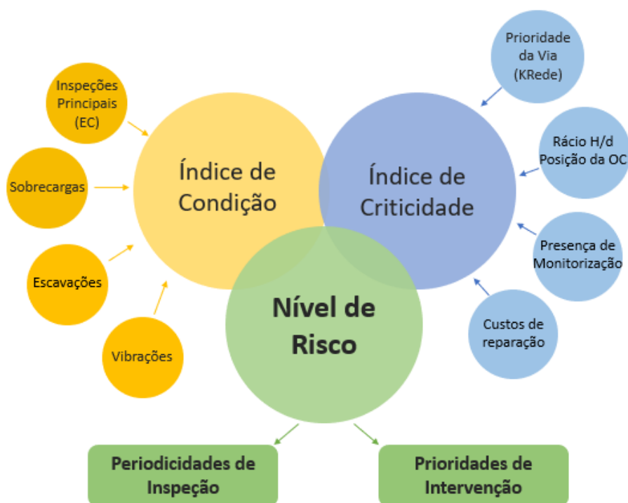
Figura 4.1 - Esquema com os fatores e parâmetros que integram o cálculo dos IC_o e IC_r , que por sua vez levam ao NR da OC.
