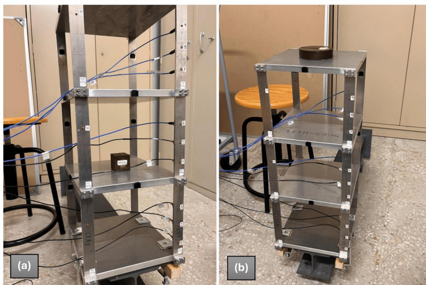
Figura 26 - Aplicação de danos nas placas. (a) Caso de dano 16 (massa de 502,7g na placa 2); (b) Caso de dano 17 (massa de 997,8g na placa 4)
