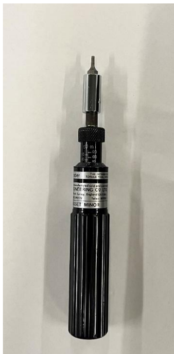
Figura 8 - Chave dinamométrica de precisão ajustada ao torque de 80 \text{ cN} \cdot m
