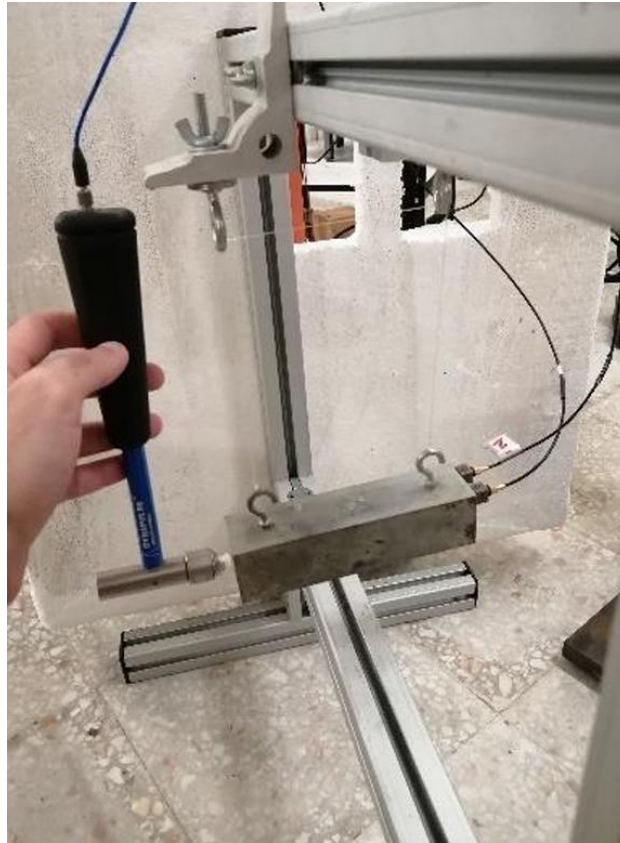
Figura 18 - Montagem experimental para calibração com massa de 2 kg. Adaptado de [32]
