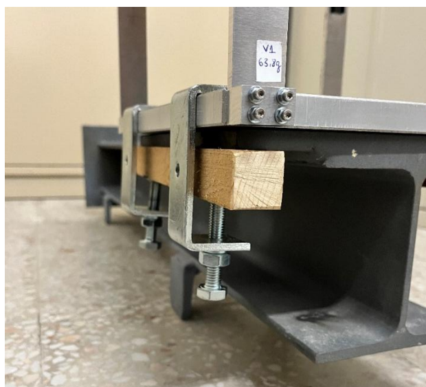
Figura 10 - Encastramento da estrutura através de grampos de fixação
