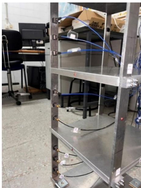
Figura 22 - Acelerômetros fixados à estrutura
