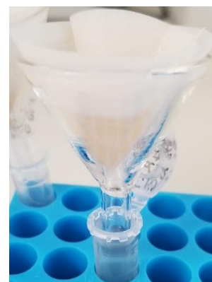
Figura 2.8 - Filtração do homogeneizado utilizando um funil e papel de filtro.
