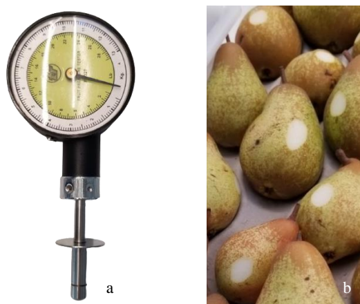
Figura 2.5 - Medição da firmeza da polpa. (a) Penetrômetro TR Turoni FT 327. (b) Peras com a epiderme removida da zona equatorial do fruto.
