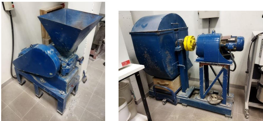
Figura 3.3 - Britador e Moinho de bolas respetivamente
