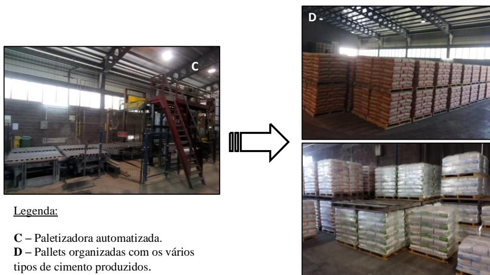
Figura 2.5 - Paletização dos respetivos sacos de cimento (C e D)
