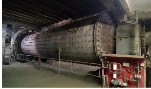
Figura 2.3 - Moinho de Bolas utilizado na moagem do clínquer
