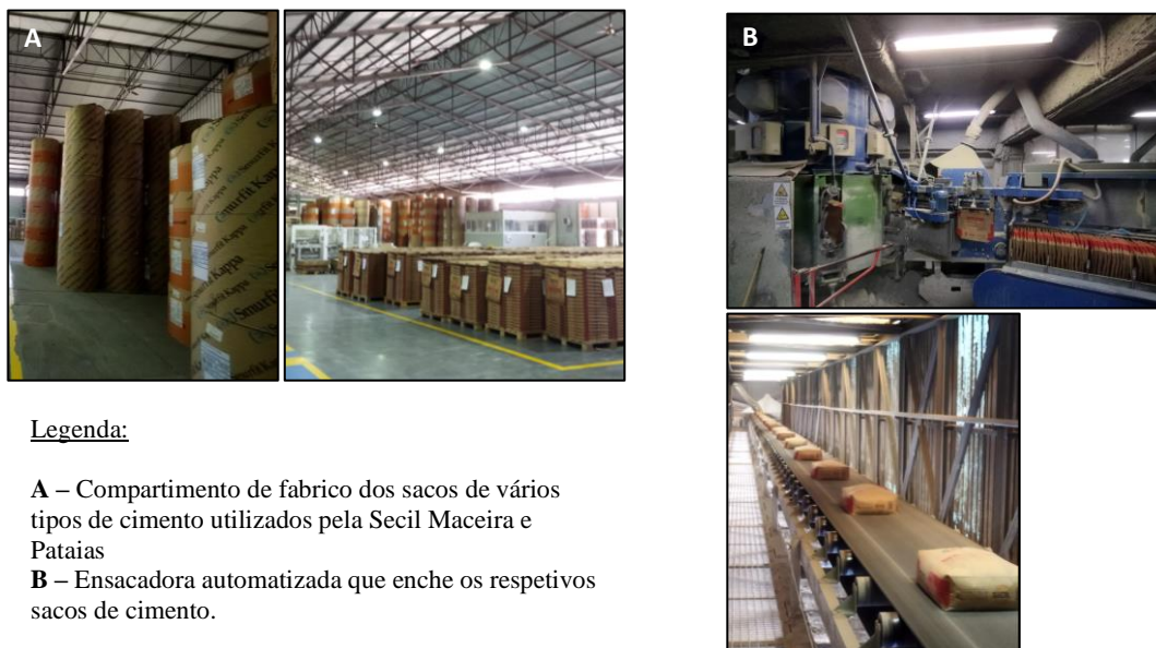
Figura 2.4 - Imagens representativas do fabrico de sacos por parte da Secil - Maceira e Pataias (A); Forma de ensacamento do cimento nos sacos (B)
