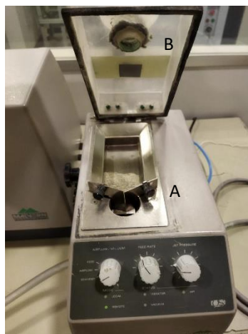
Figura 3.13 - A: Bandeja metálica onde é colocado o cimento e B: respetiva tampa que previne possíveis contaminações com outras amostras
