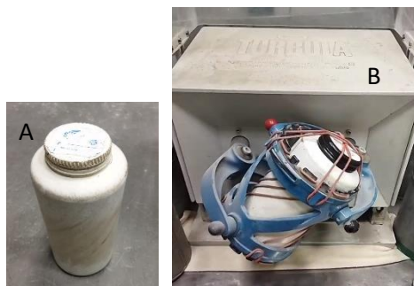
Figura 3.6 - A: representa o frasco com capacidade para 1,5kg; B: Homogeneizador/misturador do laboratório
