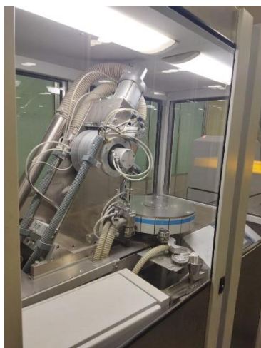
Figura 3.15 - Compartimento de introdução de matérias-primas ou cimento e formação da pastilha para posterior análise
