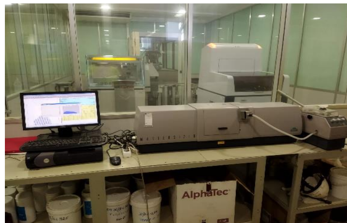
Figura 3.11 - Aparelho Malvern Mastersizer do laboratório de controlo do processo
