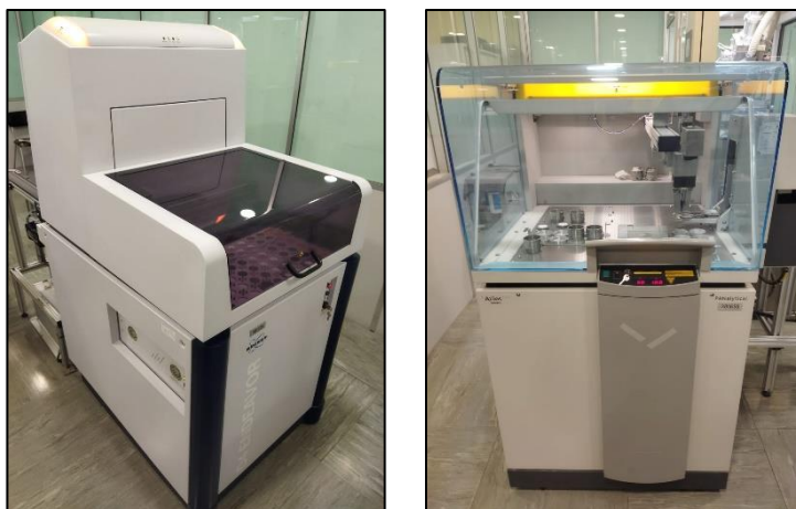
Figura 3.16 - Aparelho DRX e FRX respetivamente do Laboratório de controlo da Secil Maceira e Pataias
