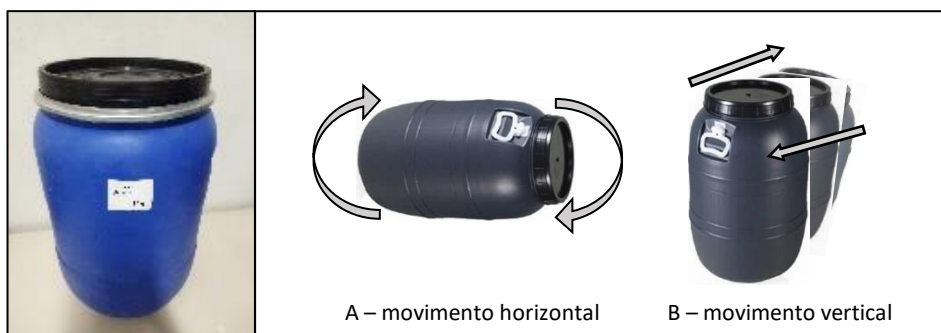
Figura 3.4 - Barrica de homogeneização e armazenamento do clínquer (A e B representam os movimentos de homogeneização do clínquer moído)
