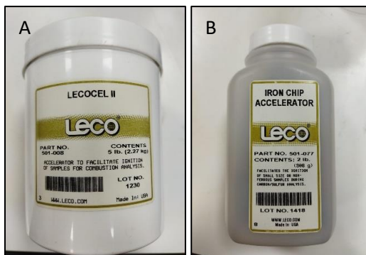
Figura 3.8 - A: Lecocel II (partículas contendo tungstênio e estanho que facilitam a ignição das amostras para análise de combustão); B: Acelerador de lascas de ferro (partículas de ferro que facilitam a ignição de pequenas amostras não ferrosas durante a análise de carbono/enxofre)
