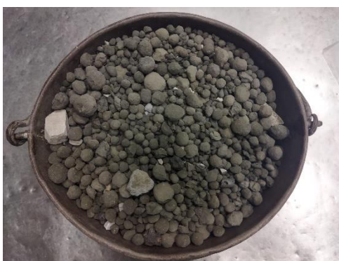
Figura 2.6 - Clínquer do forno 5 e 6, recolhido nas passadeiras transportadoras do mesmo
