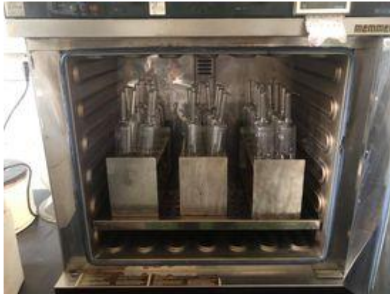
Figura A.3- Ampolas preparadas do ensaio de envelhecimento acelerado à temperatura de 80°C.
