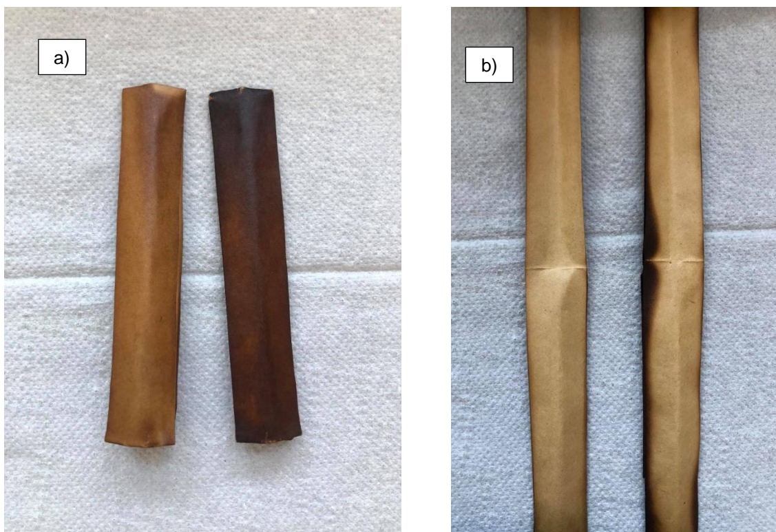
Figura 4.81- Papel isolante sujeito a substituição de óleo e papel isolante envelhecido normalmente. a) Camada exterior do papel isolante de ampolas envelhecidas normalmente, à esquerda, e ampolas sujeitas a substituição, à direita. b) Camada interior do papel isolante de ampolas envelhecidas normalmente, à esquerda, e ampolas sujeitas a substituição, à direita.
