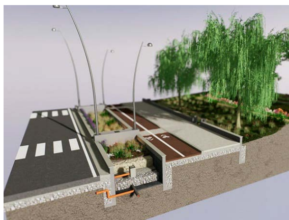
Figura 4.21 - Esquema de um jardim de chuva. (fonte: BibLus, 2020)
