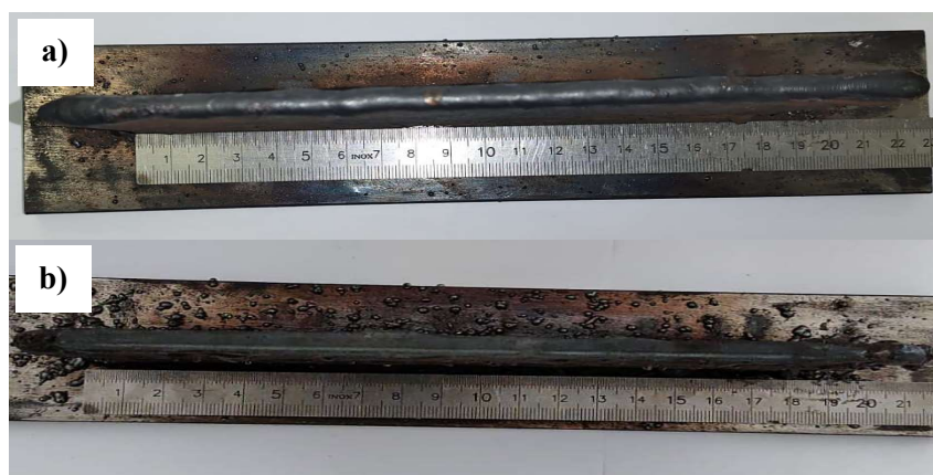
Figura 3.5 Diferença das superfícies das camadas de WAAM convencional e de HF-WAAM: a) superfície da camada de WAAM convencional; b) superfície da camada de HF-WAAM
