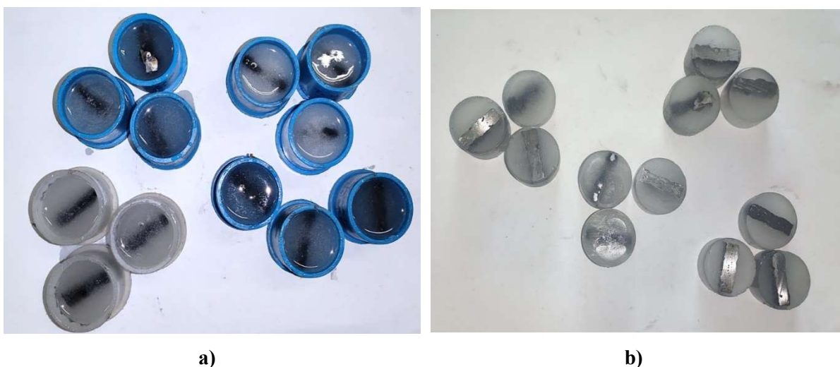
Figura 3.9 Processo de embutimento das amostras: a) embutimento das amostras; b) amostras após embutidas
