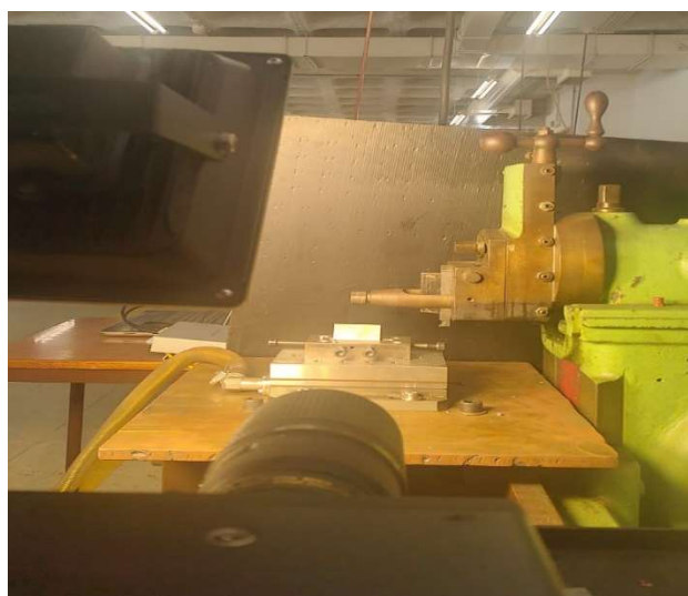
Figura 3.23 Configuração da câmara auxiliada com os holofotes
