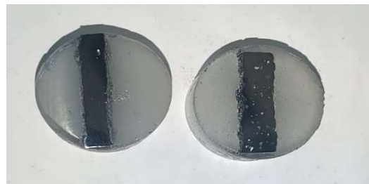
Figura 3.12 Polimento: a) pasta de diamante; b) Superfície das amostras após depois de polida
