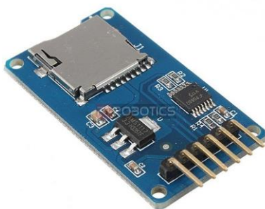
Figura 3.13 - Módulo para cartão microSD.
