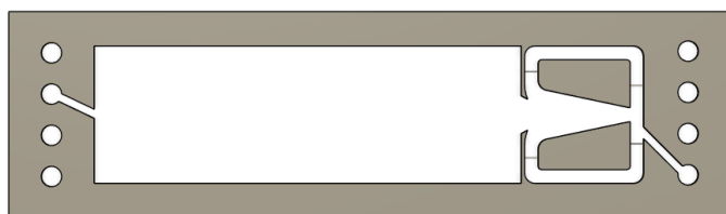
Figura 9 - Espaçador desenhado com a estrutura que promove o efeito Coanda replicada uma vez e o restante canal de fluxo sem grelha (volume ocupado pela estrutura dentro do canal de fluxo é de 0.51 \text{ cm}^3 )
