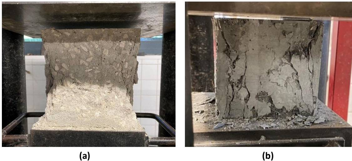
Figura 27 - Rotura de provetes cúbicos de betão normal (a) e BEDRF (b)
