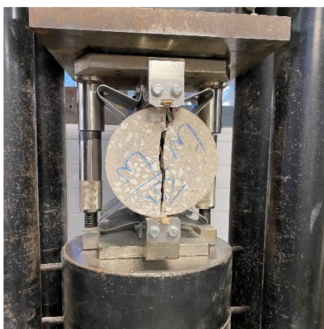
Figura 29 - Ensaio e rotura à compressão diametral
