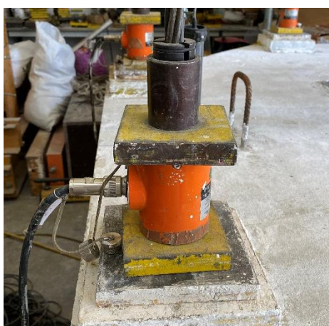
Figura 17 - Célula de carga CLC-200KNA
