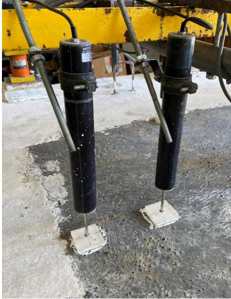
Figura 19 - Defletómetros da TML colocados na face superior e inferior
