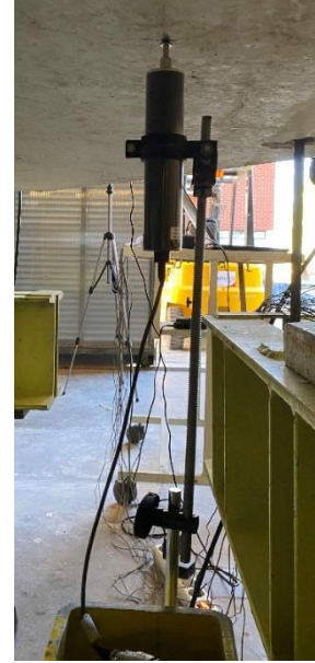
Figura 19 - Defletómetros da TML colocados na face superior e inferior
