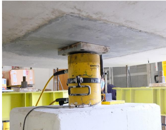
Figura 13 - Macaco hidráulico e pilar fictício
