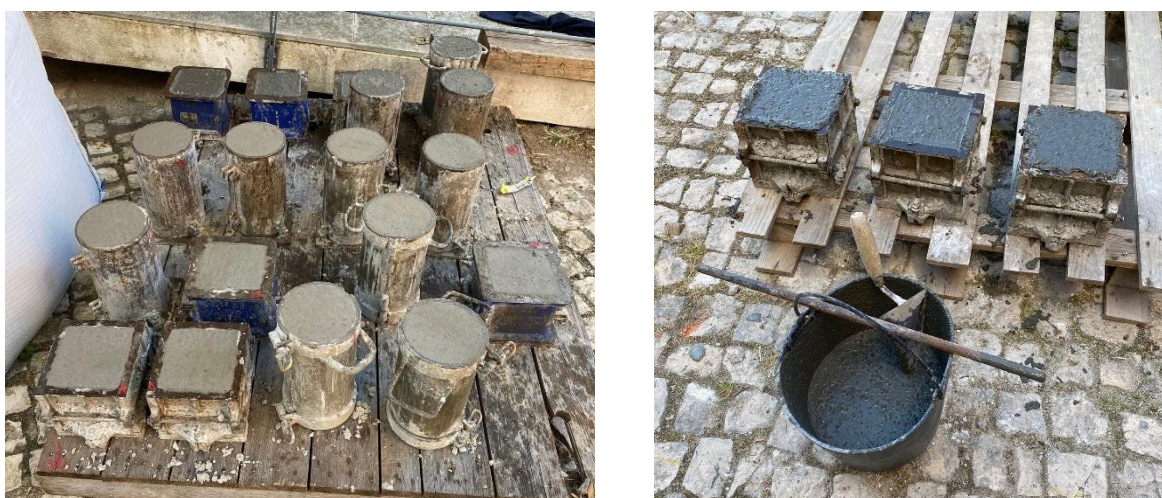
Figura 25 - Amostras de betão recolhidas em moldes cúbicos e cilíndricos e processo de recolha de amostra do betão BEDRF
