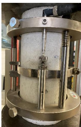
Figura 30 - Ensaio ao módulo de elasticidade
