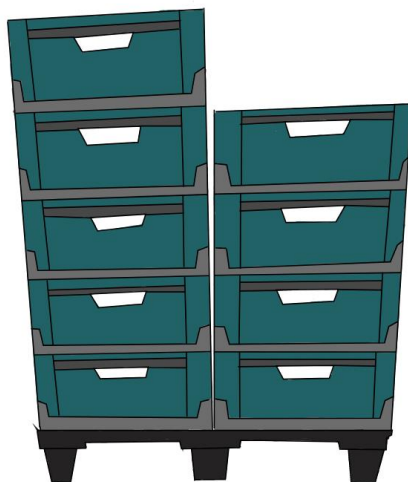
Figura 2-5 - Representação esquemática das caixas utilizadas para o embalamento para congelação da carne de porco para salsicha. Caixas de plástico empilhadas contendo carne de porco para salsicha em palete. Cada caixa contém aproximadamente 10Kg de carne revestidos com um saco de plástico azul.
