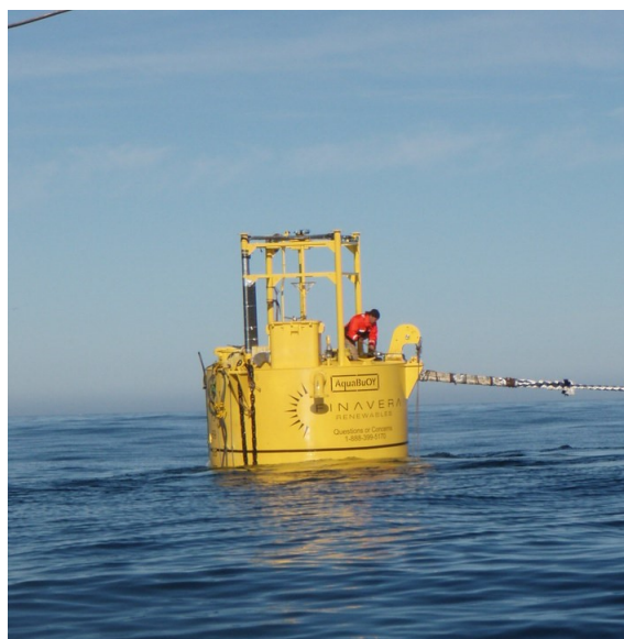
Figura 2.2: Conversor AquaBouy do tipo absorvedor pontual (Grant 2011).
