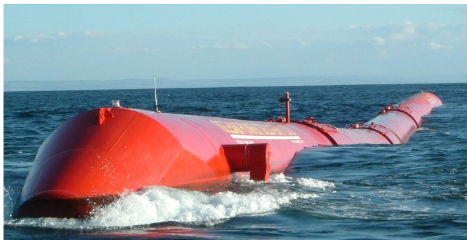
Figura 2.1: Conversor Pelamis do tipo atenuador (Reis 2015).
