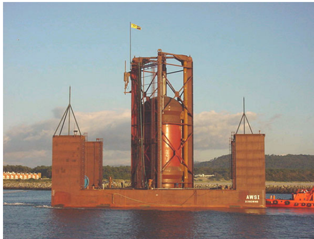
Figura 2.6: Dispositivo Protótipo AWS instalado em Viana do Castelo, Portugal (Energias 2009).
