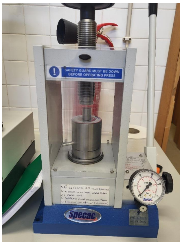
Figura 4.3 Prensa hidráulica Specac utilizada na preparação das pastilhas ( pellets ) a partir de amostras moídas.
