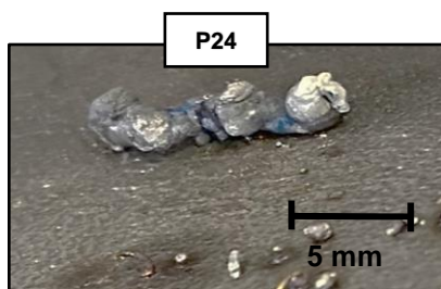
Figura 4.12 Morfologia dos cordões com fio de Cromel
