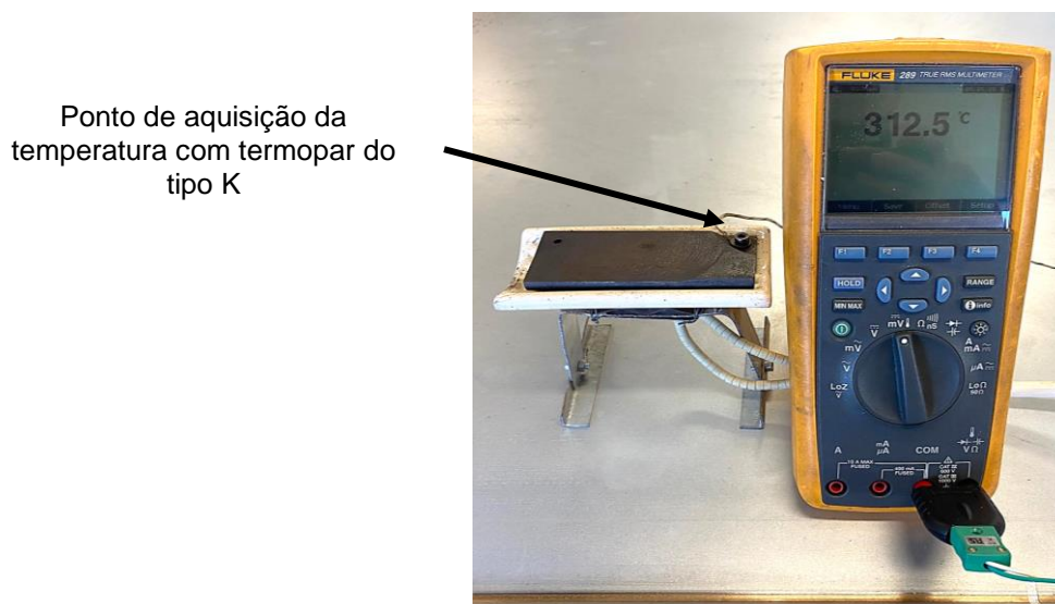
Figura 3.4 Equipamento para aquisição da temperatura do substrato
