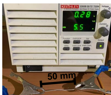
Figura 3.6 Montagem experimental para o ensaio de fusão por efeito de Joule
