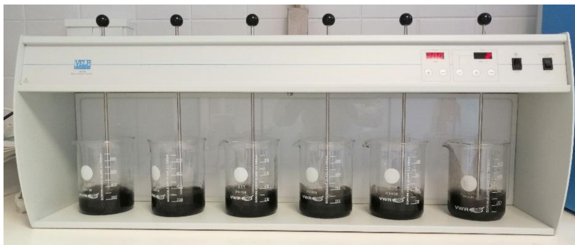
Figura 5.7-Ensaio Jar-test no condicionamento da lama mista digerida.
