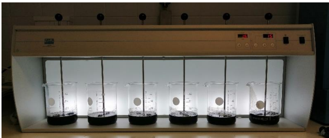
Figura 5.12-Ensaio Jar-test no condicionamento da lama mista.
