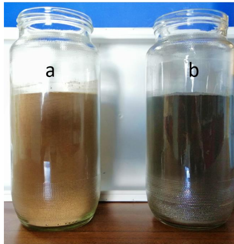
Figura 4.1- Lamas de ETA da Asseiceira (a) e de Santa Águeda (b), vista perfil
