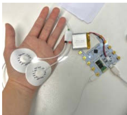
Figura 4.4 - Configuração dos elétrodos para registo de atividade eletrodérmica.
