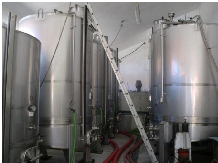
Figura 4.6 – Cubas de inox utilizadas na fermentação do mosto.
