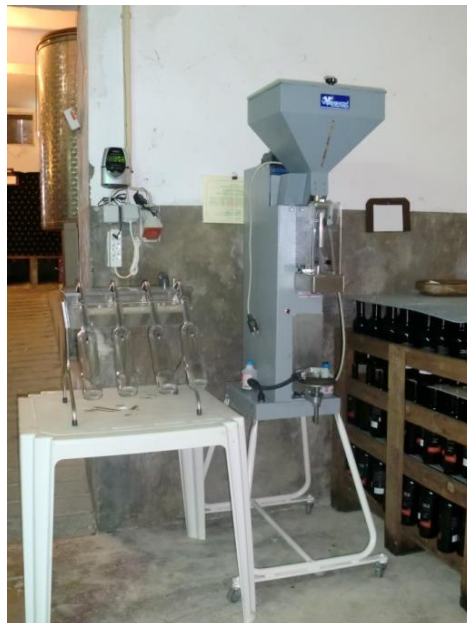
Figura 4.9 – Enchedora e rolhadora semi-automáticas utilizadas no engarrafamento dos vinhos.
