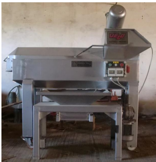
Figura 4.5 – Máquina desengaçadeira utilizada na remoção do engaço e esmagamento das uvas.
