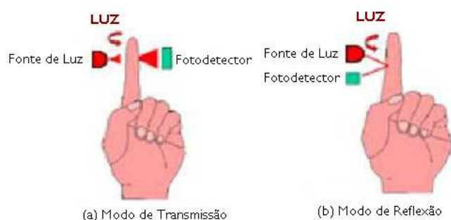
Figura 2.5: Esquema dos modos de fotopleletismografia: transmissão (a) e reflexão (b) - Adaptado de [22].
