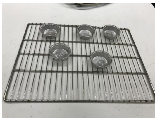
Figura 3.8 - Tabuleiro com formas de alumínio para curva de voláteis (Laboratório Resibras)
