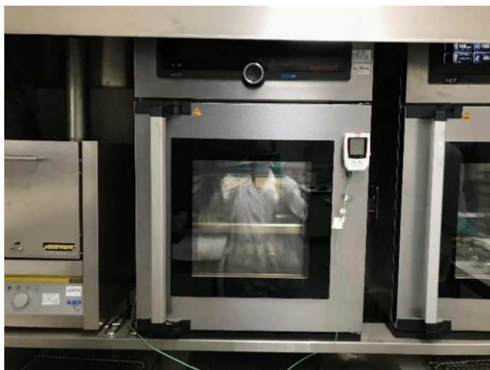
Figura 3.10 - Montagem do ensaio de estabilidade térmica (com porta fechada) (Laboratório Resibras)
