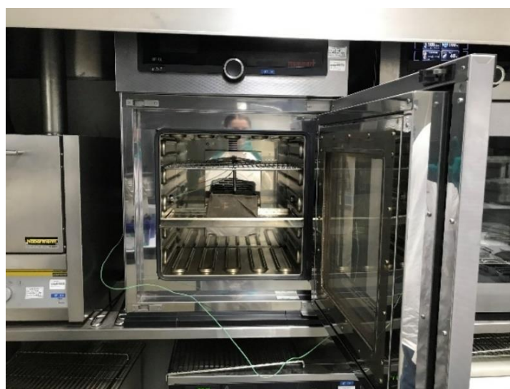
Figura 3.9 - Montagem do ensaio de estabilidade térmica (com porta aberta) (Laboratório Resibras)
