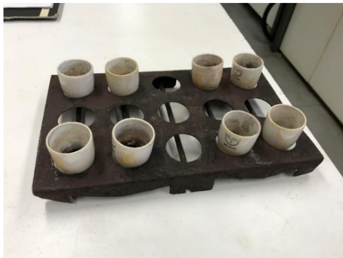
Figura 3.7 - Tabuleiro com cadinhos para ensaios de voláteis a 105°C ou 162°C (Laboratório Resibras)
