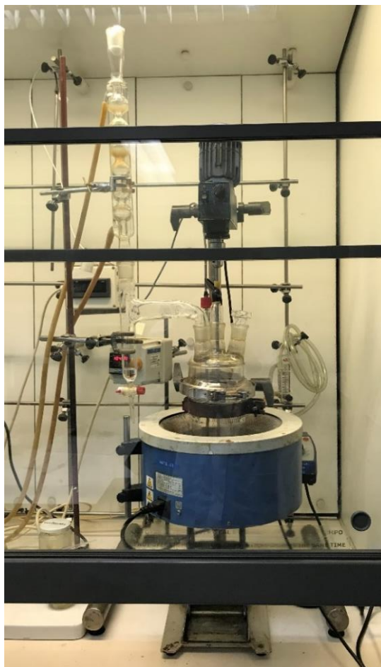
Figura 3.3 - Montagem para a polimerização de CNSL hidrogenado com ácido sulfúrico (Laboratório Resibras)
