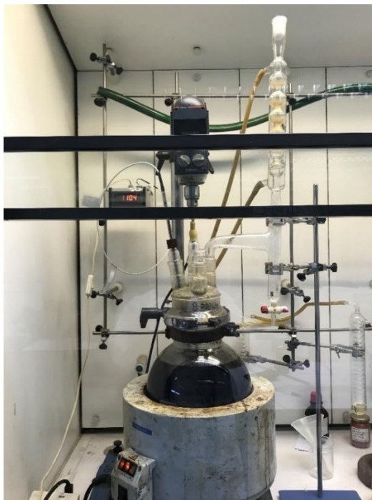
Figura 3.1 - Montagem para a polimerização de CNSL com ácido sulfúrico (Laboratório Resibras)
