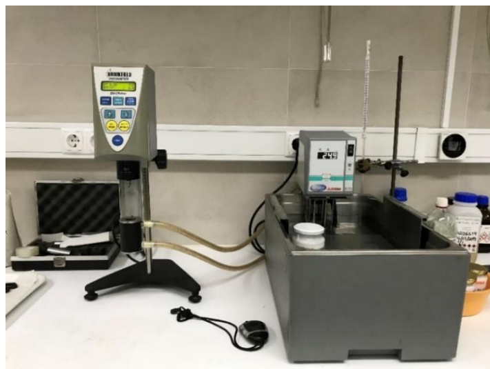
Figura 3.6 - Viscosímetro de Cilindro Coaxial (ou de Brookfield) (Laboratório Resibras)
