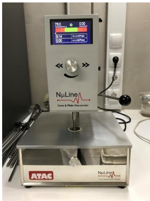
Figura 3.5 – Viscosímetro rotacional com geometria de Cone e Prato (Laboratório Resibras)
