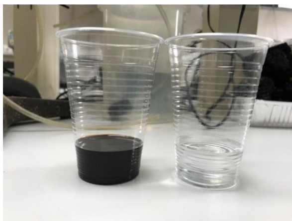
Figura 3.12 - Preparação para a medição do pH de CNSL e polímero de CNSL (Laboratório Resibras)
