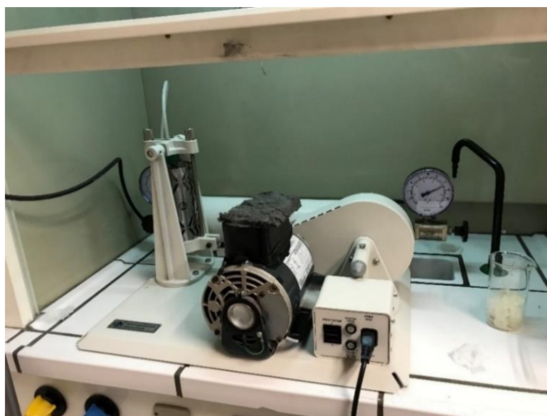
Figura 3.2 - Montagem do hidrogenador (Laboratório FCT NOVA)
