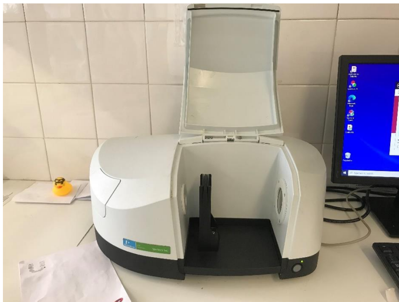
Figura 3.14 - Aparelho de Infravermelhos com módulo para KBr (Laboratório FCT NOVA)
