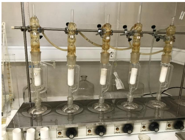
Figura 3.11 - Montagem para o ensaio de percentagem de extraíveis por acetona (Laboratório Resibras)
