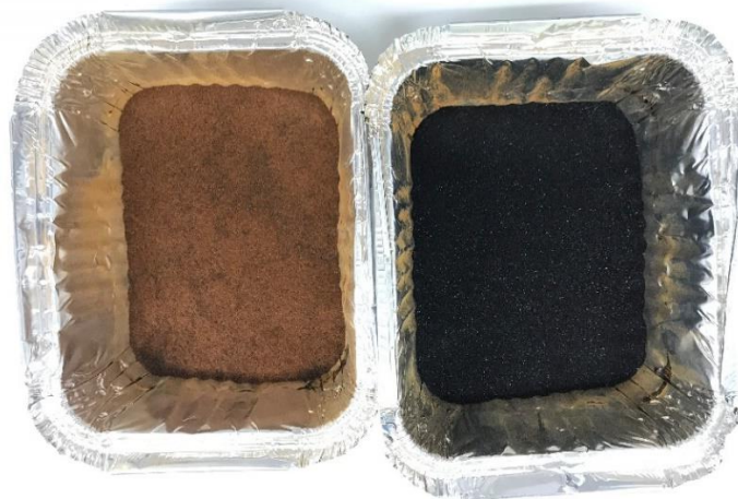
Figura 4.27 - Comparação visual entre pó castanho (Paraformaldeído) e pó negro (Furfural)
